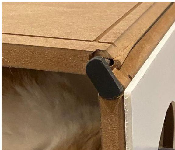
Al momento de mecanizar la madera por primera vez y con el diseño del nodo de unión anterior, se detecta una dificultad de fidelidad con la forma interior de la caja donde se encastra el nodo de unión. Esto nos lleva a pensar en otras formas ortogonales que mitiguen la posibilidad de error en el mecanizado, al mantener las formas de la caja más simples y rectas.
