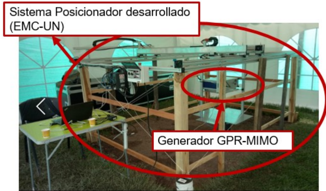
Figura 3-1.: Sistema de posicionamiento potable, desarrollado en la Universidad Nacional de Colombia, para la detección de AEIs sustitutos bajo condiciones semi-reales (11).
