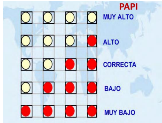
Figura 39. Iluminación de luces PAPI en aterrizaje. - tomado de: organización de aviación civil internacional (Chacin, 2016)
