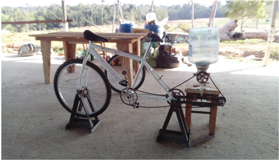
Ilustración 38: Prototipo para moler granos de cacao a partir de bicicleta. Fuente: Autor - Febrero del 2018
