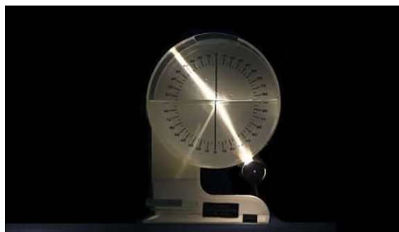
Figura 2-1.: Refracción y reflexión de la luz al cambiar de medio [Fernández, 2016].
