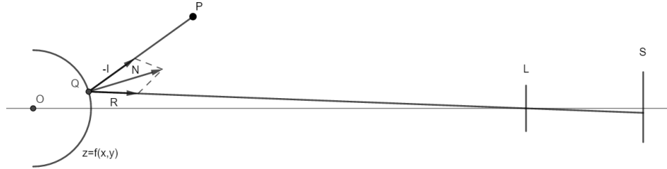
Figura 4-7.: Esquema vectorial de la reflexión de un punto de luz en la córnea.
