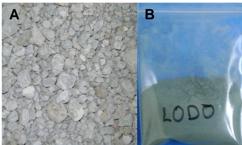
Imagen 2.1 Muestras de (A) lodo seco, (B) lodo seco, molido y tamizado
