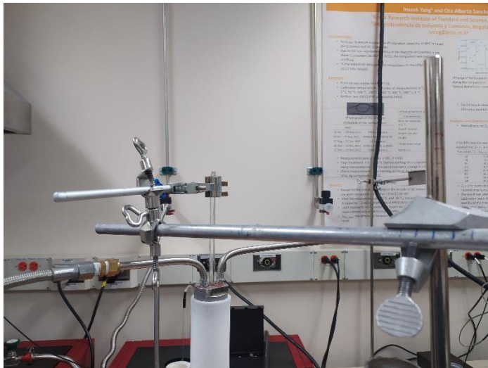
Figura 3-16: Inserción de la varilla de cuarzo para empujar el termopozo dentro del crisol.
