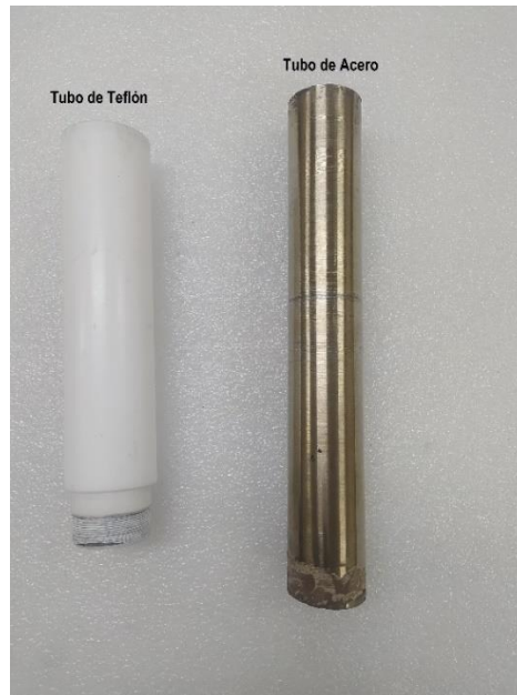
Figura 3-14: Cilindros de teflón y de acero para el proceso de llenado de la celda.
