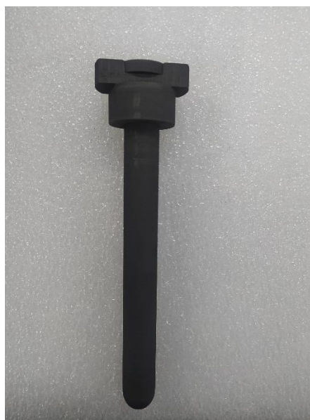
Figura 3-5: Vista lateral del termopozo en la tapa.
