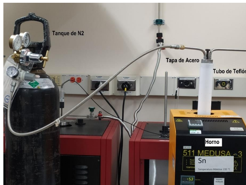
Figura 3-15: Sistema para la fundición del indio dentro del crisol.
