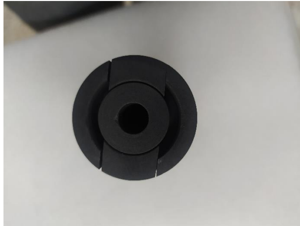
Figura 3-6: Vista superior del ensamble crisol-tapa-termopozo de grafito.
