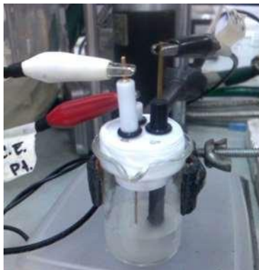
Figura 3-1: Arreglo experimental para realización de Voltamperometría Cíclica.
