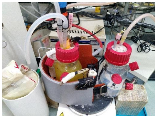
Figura 3-2: Arreglo experimental para cultivo en reactor H por lote.
