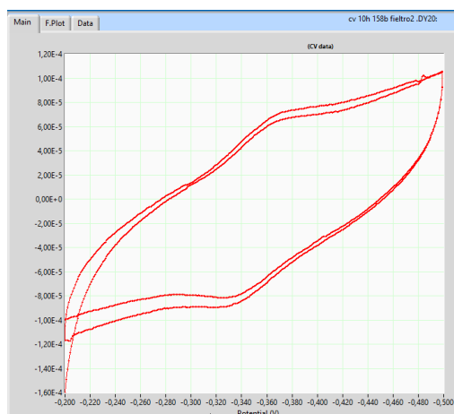
Figura 4-8: CV de IBUN 158B en electrodo de fieltro de grafito.
