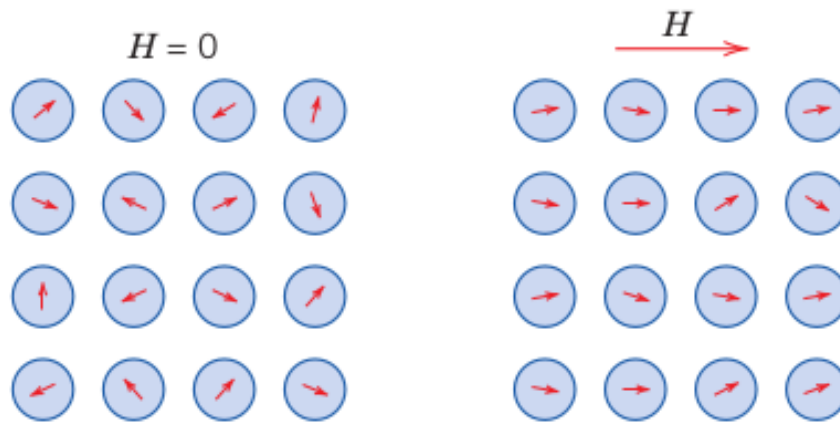
Figura 2-10.: Comportamiento de un material paramagnético con y sin campo magnético externo. Tomado de [3].
