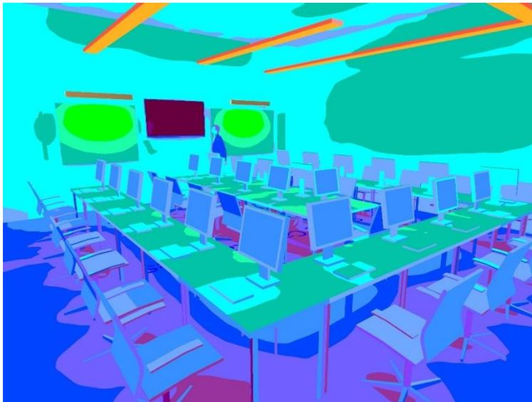
El uso de colores falsos permite realizar una evaluación aproximada del comportamiento de la iluminación en el espacio bajo análisis. Para el caso de la iluminación propuesta para la sala de capacitaciones, de la **Figura 3-38** se puede evidenciar que los niveles de luminancia en el campo visual son muy uniformes, presentando un realce de los tableros
