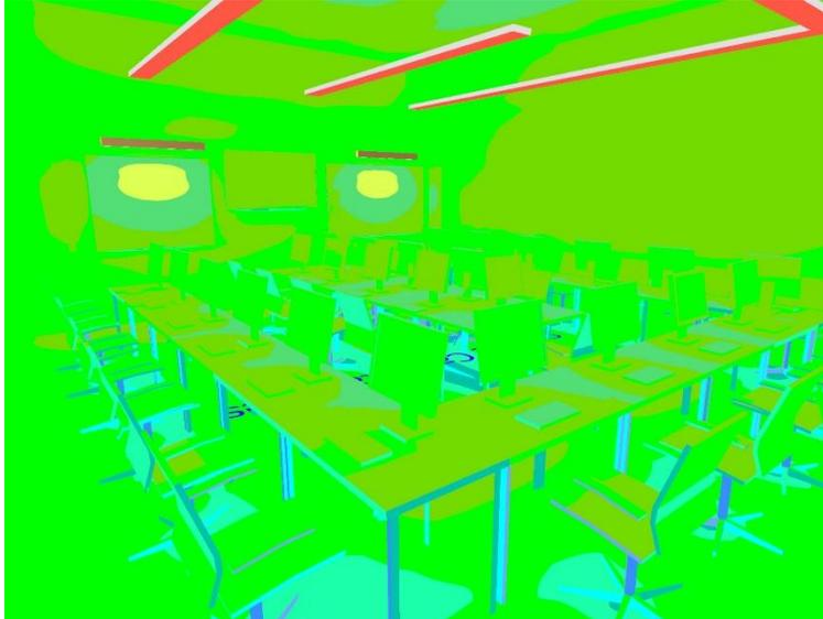
**Figura 3-38:** Colores falsos de la luminancia de la sala de capacitaciones, utilizando la propuesta de iluminación integradora.
