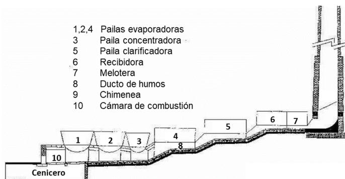
**Figura 1-1.** Sistema de calentamiento de un trapiche tradicional.
