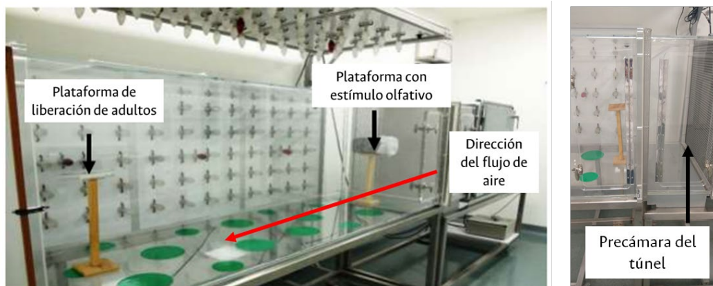
Figura 4.2. Montaje túnel de viento empleado para la evaluación de la respuesta comportamental de adultos de Opsiphanes cassina .
