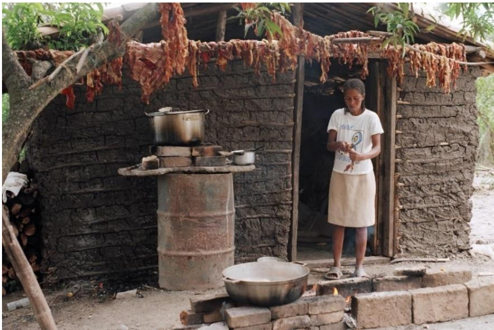
Figura 3-176: El uso del bahareque se encuentra en casas básicas y en las cocinas exteriores. Imagen de Jenny Jojoa (Alban, 2007, pág. 308).
