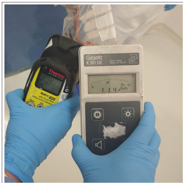
Figura 5-11.: Equipos medidores de tasa de dosis equivalente ambiental
