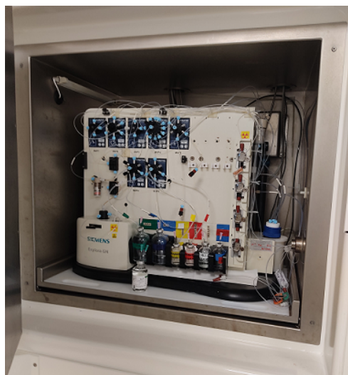
Figura 3-3.: Sistema de procesamiento químico para la unión de ^{18}\text{F} – FDG. Tomada en Ciclotrón Colombia, Medellín.
