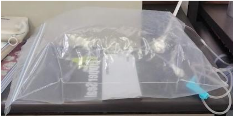
Figura 4.1 Cámara de Hipoxia. Se muestra prototipo de cámara de hipoxia de bajo costo a partir de bolsas de polipropileno con cierre tipo ziploc conectada a dos dispositivos reguladores del flujo para la entrada y salida de mezcla de gases (N 2 95% C O2 5%)
