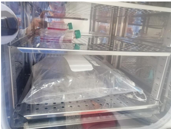
Figura 4.2. Montaje de Cámara de Hipoxia en Incubación con platos de cultivo: Se muestra montaje para privación de oxígeno, los platos de cultivo están en el interior de la cámara con la mezcla de gases hasta el 80% de su capacidad, y esta se lleva a incubadora bajo condiciones usuales de cultivos celulares por el tiempo de hipoxia determinado.
