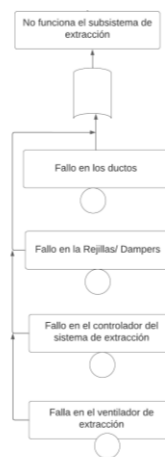
Ilustración 18. FTA sistema de extracción.
