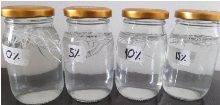
Fotografía 3-8: Fibras de polipropileno/polietileno en concentraciones de iones alcalinos
