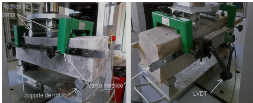
Fotografía 4-6: Configuración e instrumentación ensayo módulo de rotura.
