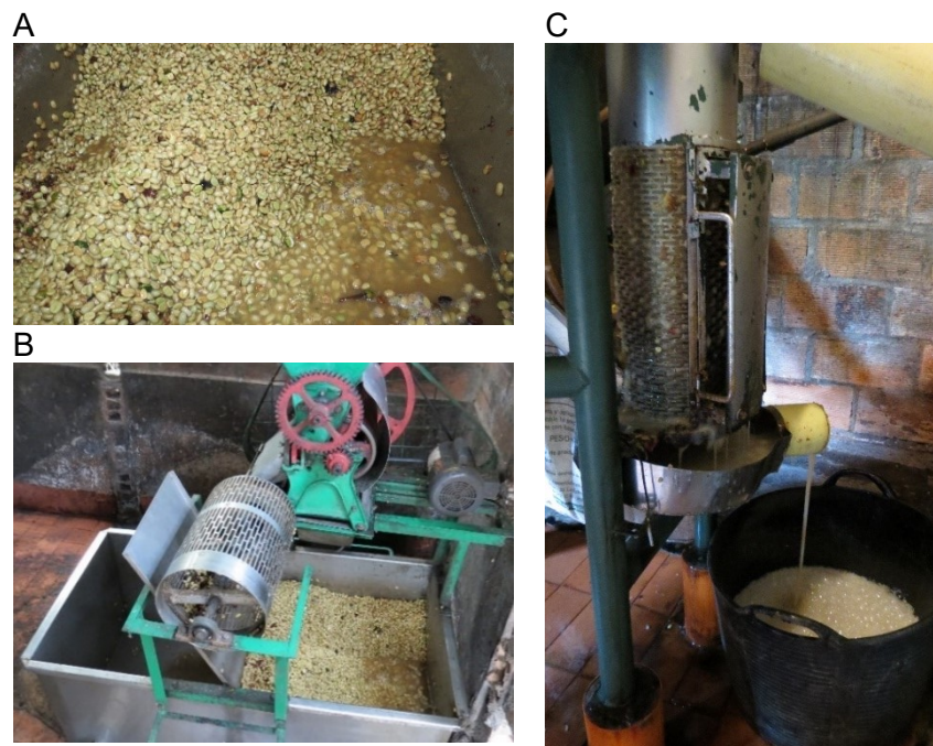
Figura 1-4. Procesos para la remoción de mucílago de café. A y B. Fermentación Natural en tanques. C. Desmucilaginado Mecánico.
