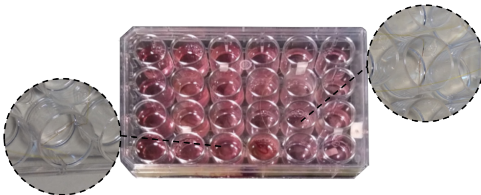
Figura 3-1.: Placa de cultivo MatTek de 24 pozos con sensores FBG, en esta se puede apreciar la ruptura de la fibra óptica debido a dobleces que excedían su radio de curvatura.
