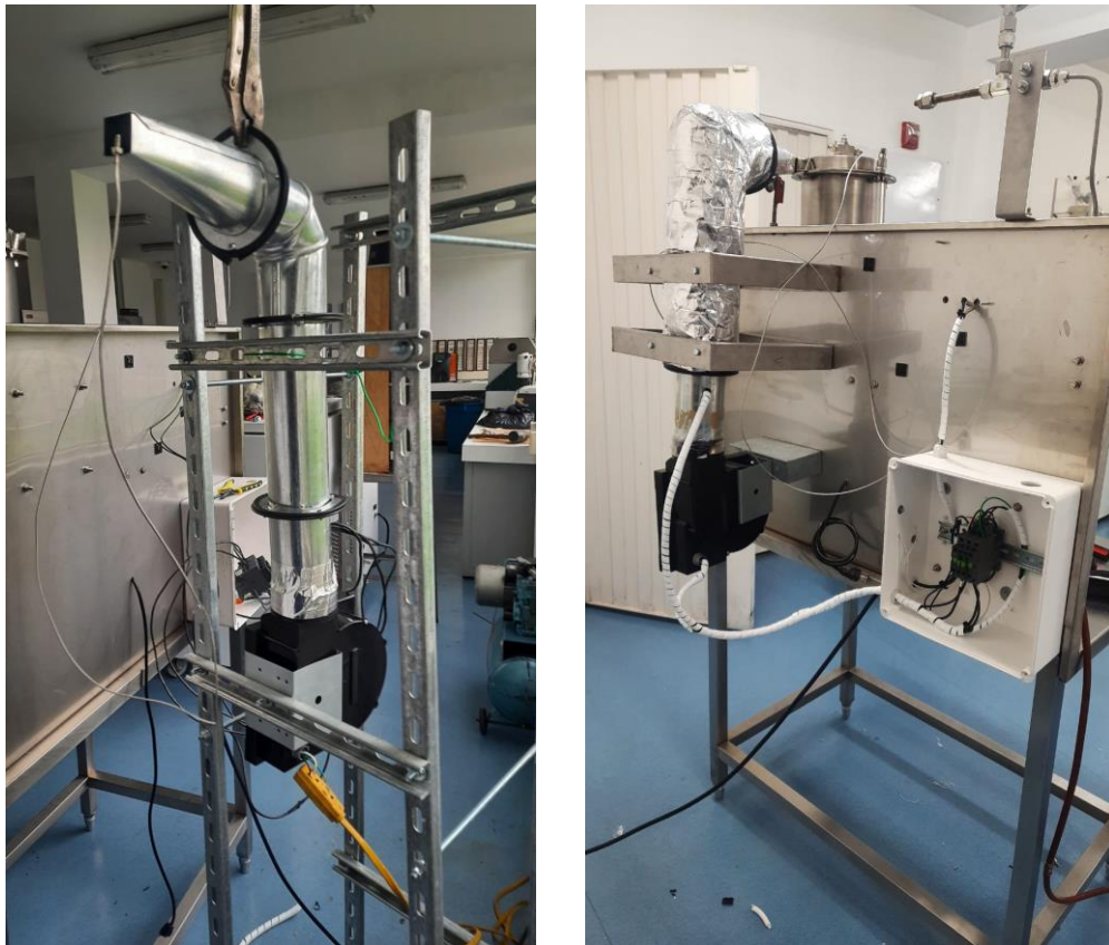
Figura 12: Montaje del sistema de calentamiento. (Autores)
