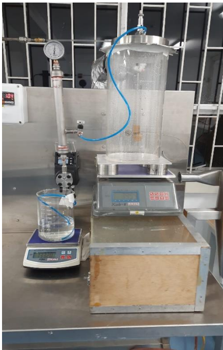
Figura 16: Montaje experimental para optimizar el caudal de alimentación. (Autores)
