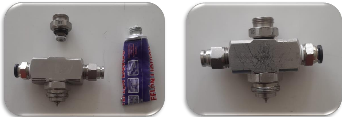
Figura 12: Acople Conexión del mecanismo autolimpiante al cuerpo del aspersor.
