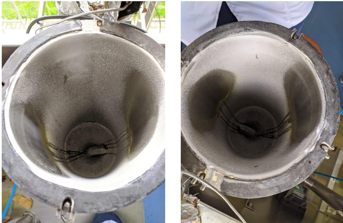
Figura 19: Resultados aspersion de zumo de naranja, con presión de aire en 1,5 bar; caudal de líquido en 0,1 l/h; temperaturas de entrada y salida en 200/80 °C y maltodextrina en 10 % (p/p). (Autores)
