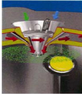
Figura 4: Atomizador rotativo. (Bibliografía [10])
