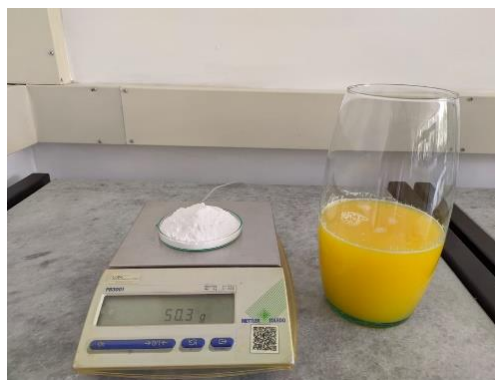
Figura 18: Pesaje maltodextrina para incorporar al zumo de naranja (Autores)
