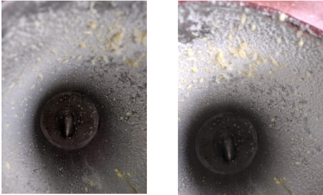
Figura 20: Resultados aspersión de zumo de naranja, con presión de aire en 1,8 bar; caudal de líquido en 0,1 l/h; temperaturas de entrada y salida en 200/80 °C y maltodextrina en 10 % (p/p). (Autores).
