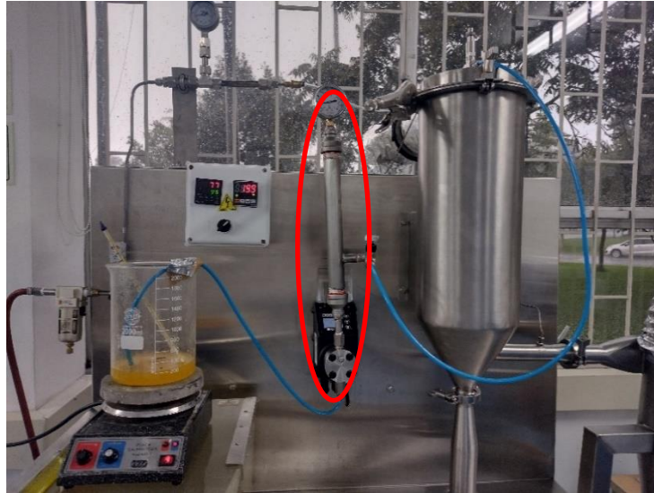
Figura 15: Amortiguador de pulsos bomba dosificadora (Autores)
