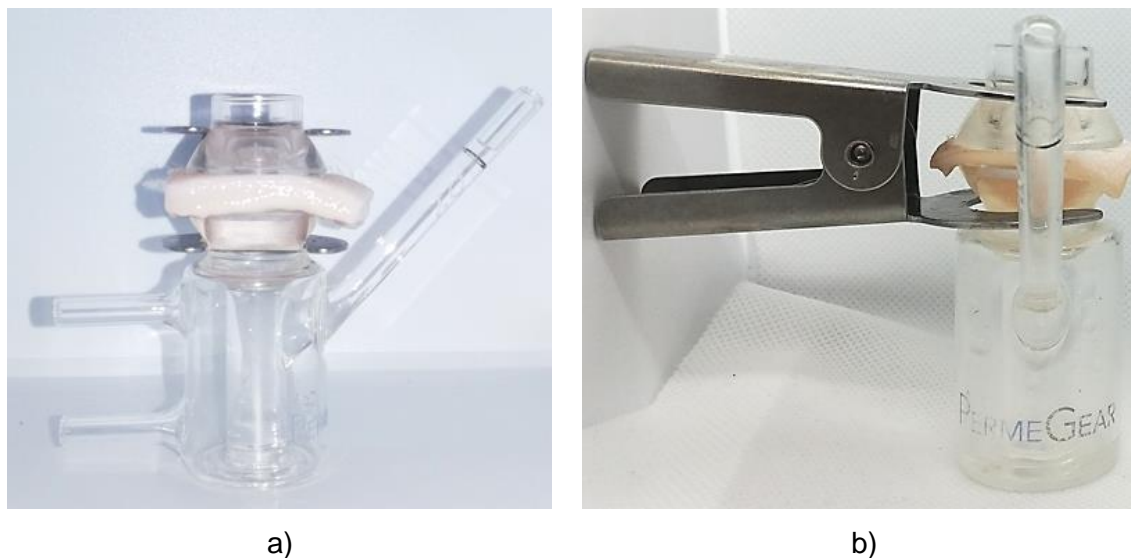
Figura 4-23: Celdas de difusión de Franz con dos espesores de membrana a) membrana con tejido hipodérmico (DEH) y b) membrana dermoepidérmica (DE).
