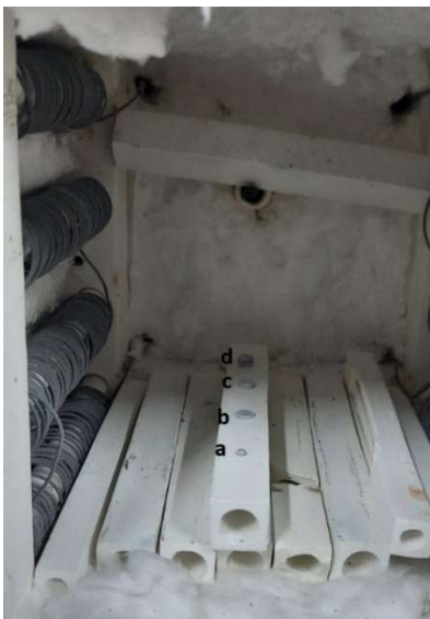
Figura 8 Tratamiento térmico muestras a) Muestra #1, b) Muestra # 11, c) Muestra # 12 y d) Muestra # 13. Diámetros de 3mm y altura 1.05mm.
