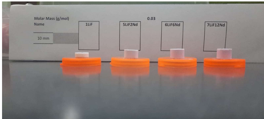
Figura 6 Pastillas de LiF con dopaje de NdF 3 .
