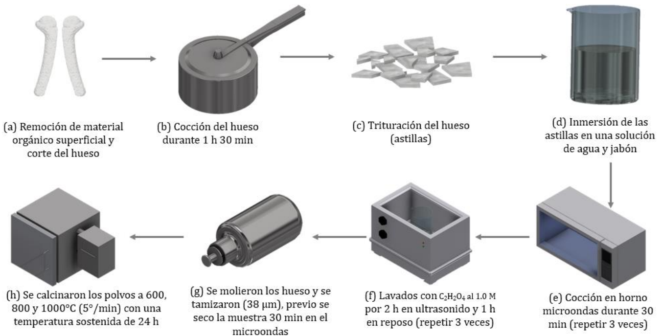
Figura 7. Metodología obtención de hidroxiapatita a partir de fuente natural.
