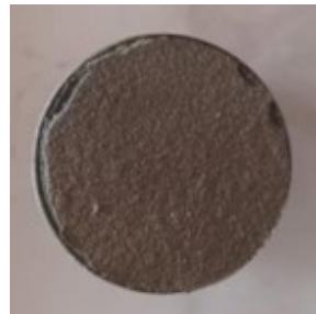
falla de pruebas ASTM C633
