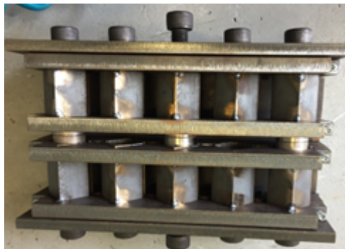
Figura 4-17.: Montaje de muestras para prueba pull off ASTM C633
