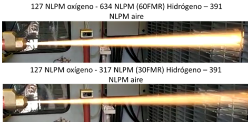
Figura 5-1.: Inspección visual del jet de combustión HVOF
