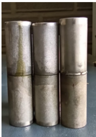
Figura 4-18.: alineación de muestras para prueba pull off ASTM C633
