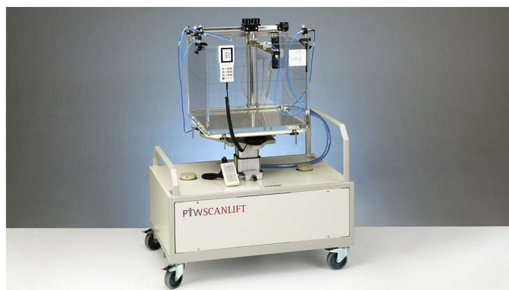
Figura 12: Simulador físico PTW SCANLIFT (Imagen tomada de [www.ptwbeamscan.com](http://www.ptwbeamscan.com))
