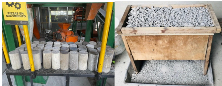
Figura 7-5: Agregado reciclado de bloque de concreto. (elaboración propia)
