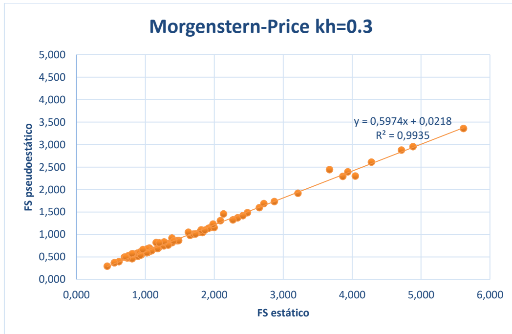
Gráfico 4-12. FS estático VS FS pseudoestático para kh=0.3 con el método de Morgenstern-Price
