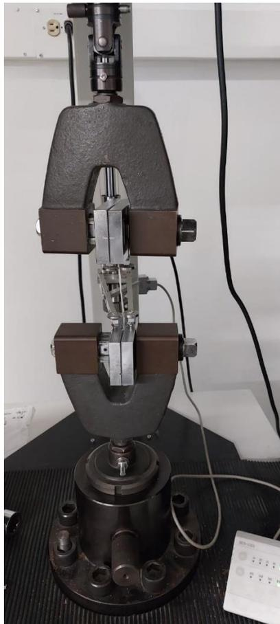
Debido a la baja adherencia de las películas, se decidió cubrir el área de agarre de las mordazas con papel para mejorar el agarre efectivo. También se aplicó cinta al módulo de extensómetro para facilitar su movimiento durante la deformación de la muestra. Una vez que montada la muestra, como se observa en la **Figura 2-8**, se realizó la calibración de todos los puntos de medición, incluyendo la carga máxima, el desplazamiento y el
