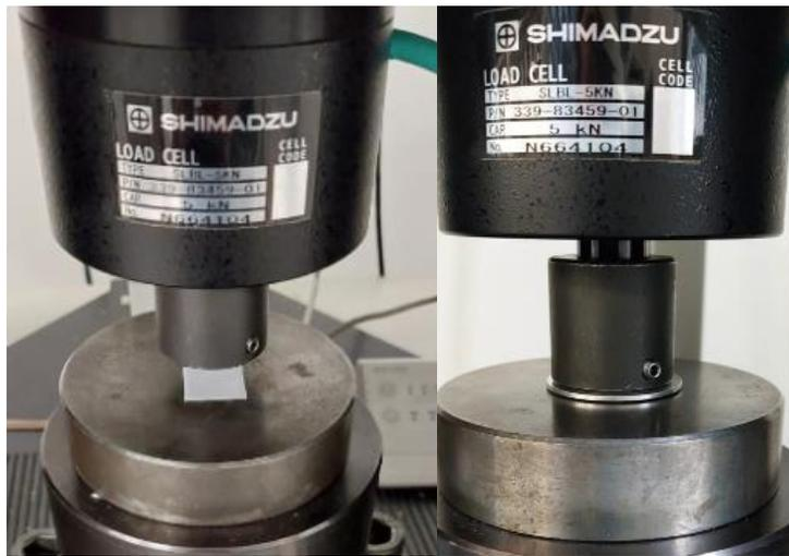
Como se muestra en la **Figura 2-9**, el andamio se coloca sobre un plato base que luego entra en contacto con la celda de carga. Para mejorar el área de contacto entre la celda y el andamio, se introdujo un cono de aluminio con un diámetro de 1 pulgada. Las mediciones obtenidas en el experimento incluyeron la carga máxima, el desplazamiento máximo, el esfuerzo y el módulo elástico.
