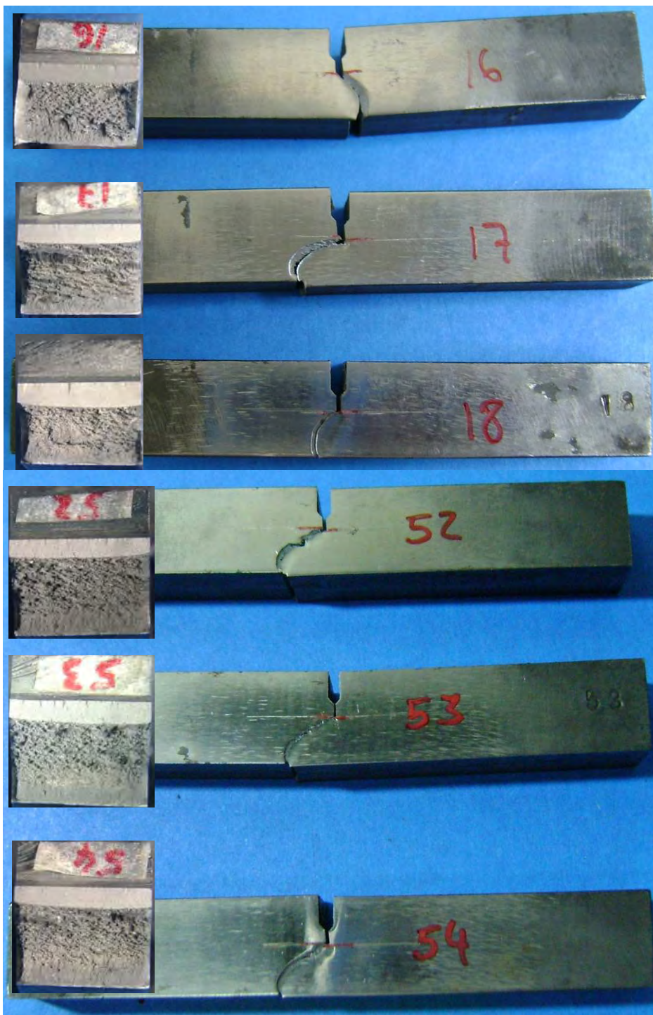
Apéndice D6. Tipo de trayectoria de grieta, probetas revenidas a 500°C.
