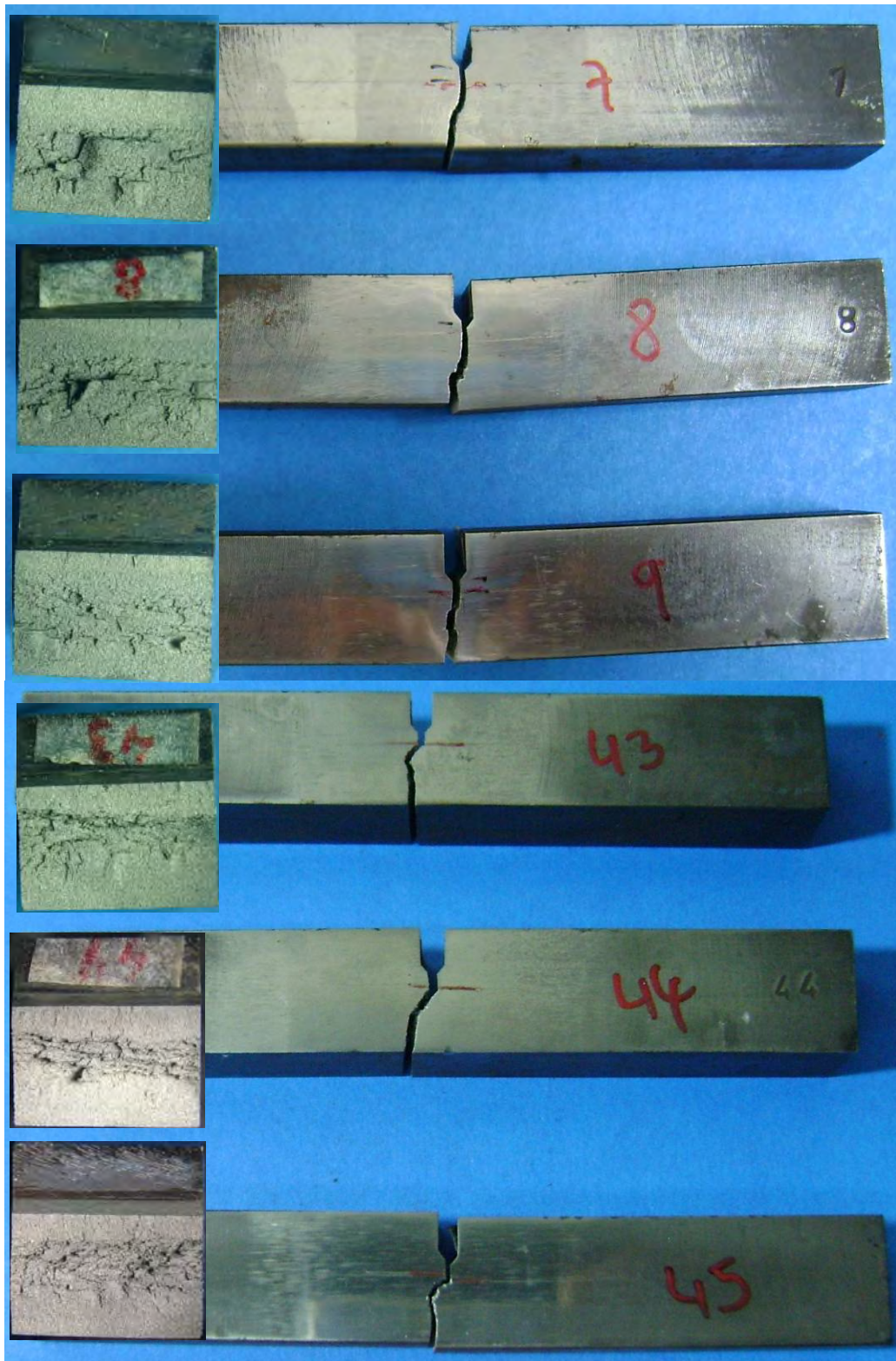
Apéndice D3. Tipo de trayectoria de grieta, probetas revenidas a 350°C.
