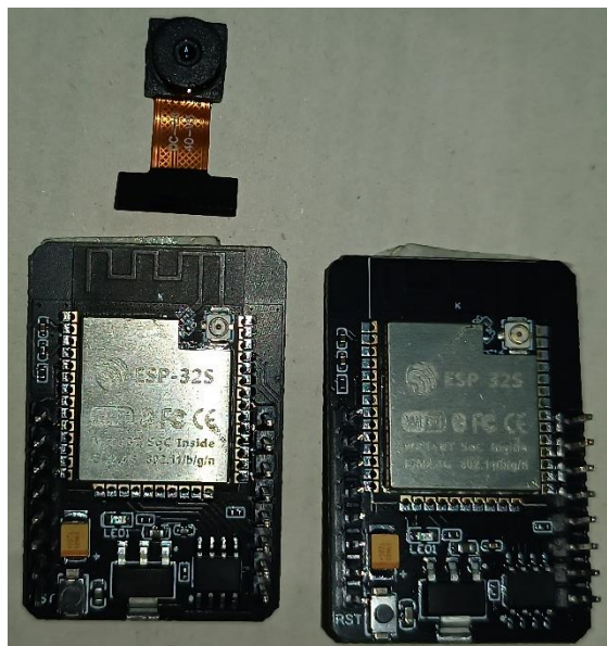
Figura 6-1: Placa de desarrollo AI-Thinker ESP32 + Cámara - Anverso
