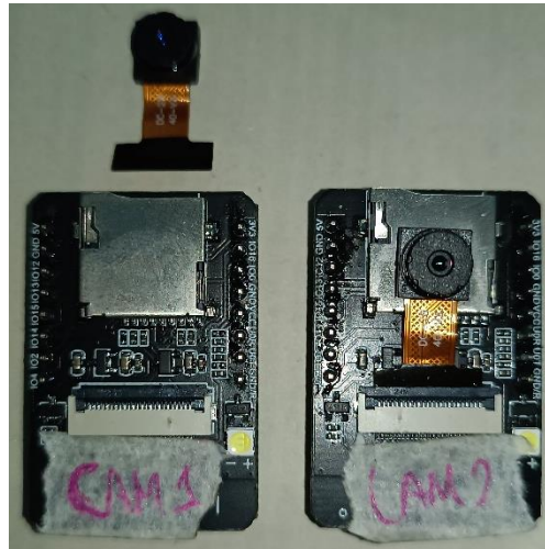
Figura 6-2: Placa de desarrollo AI-Thinker ESP32 + Cámara - Reverso
