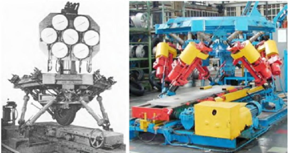
**Figura 1-5:** El primer hexápodo octaédrico o la plataforma Gough original al nacer en 1954 (Proc. IMechE, 1965-66) y poco antes de retirarse en 2000 (cortesía de Mike Beeson, Dunlop Tires). [4]
