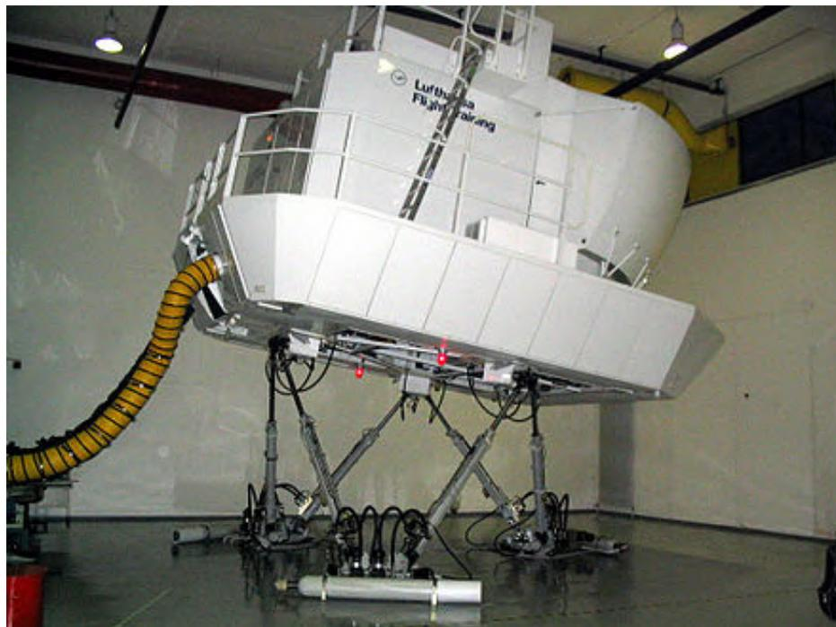
Figura 1-7: Plataforma Stewart usada por Lufthansa como simulador de vuelo. [5]
