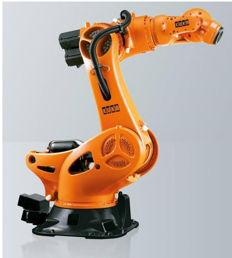
Figura 1-2: Robot de arquitectura serial marca KUKA. [30]
