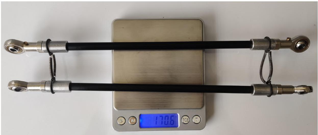
**Figura B-11:** Medición de la masa de eslabón pasivo. [Autor]
