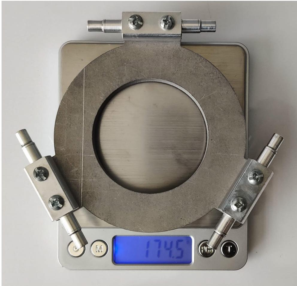
**Figura B-12:** Medición de la masa de la base móvil. [Autor]
