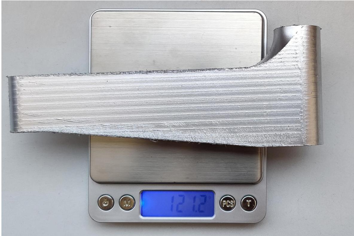
**Figura B-10:** Medición de la masa de eslabón activo. [Autor]
