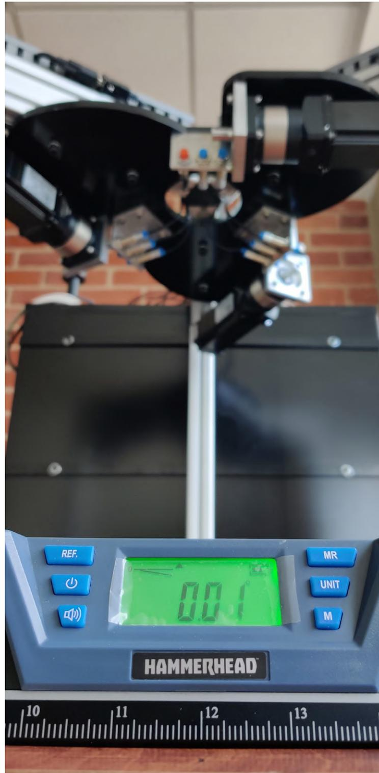
Figura B-20: Destalle de la nivelación de la mesa de trabajo. [Autor]
