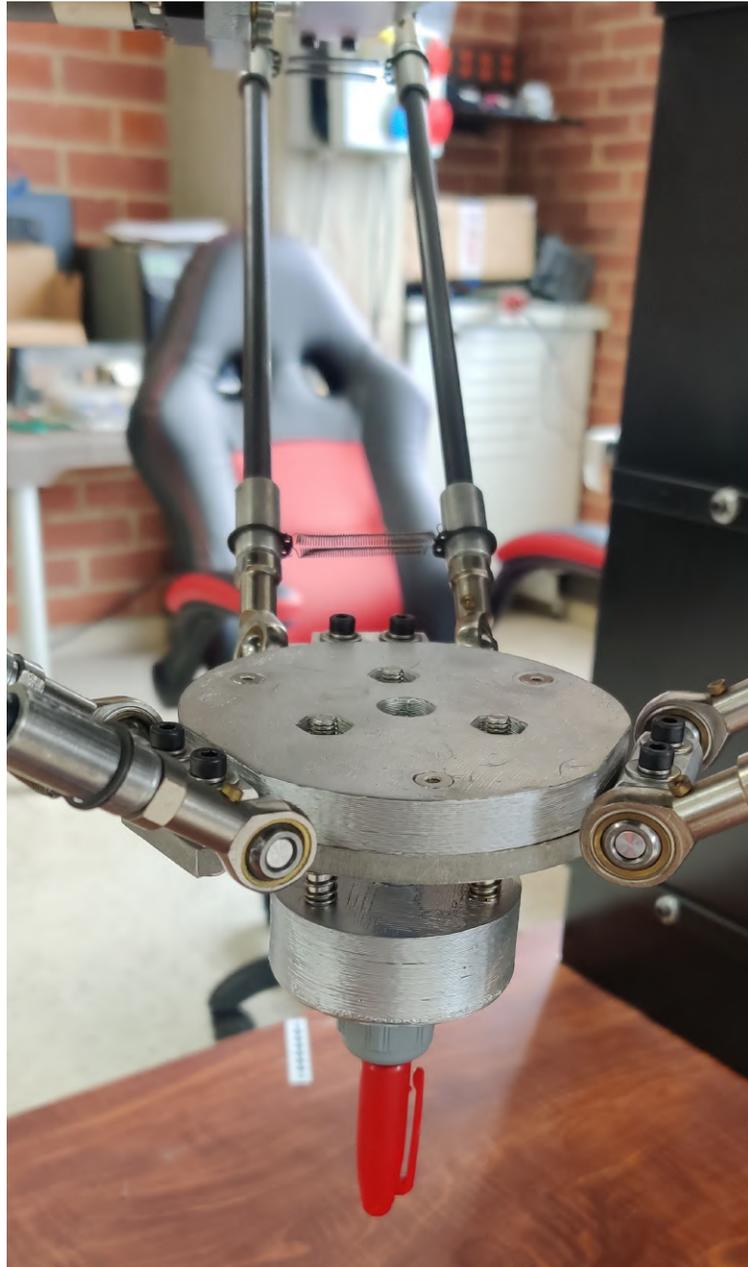
**Figura B-18:** Pinza robótica para anclaje de marcador permanente. [Autor]
