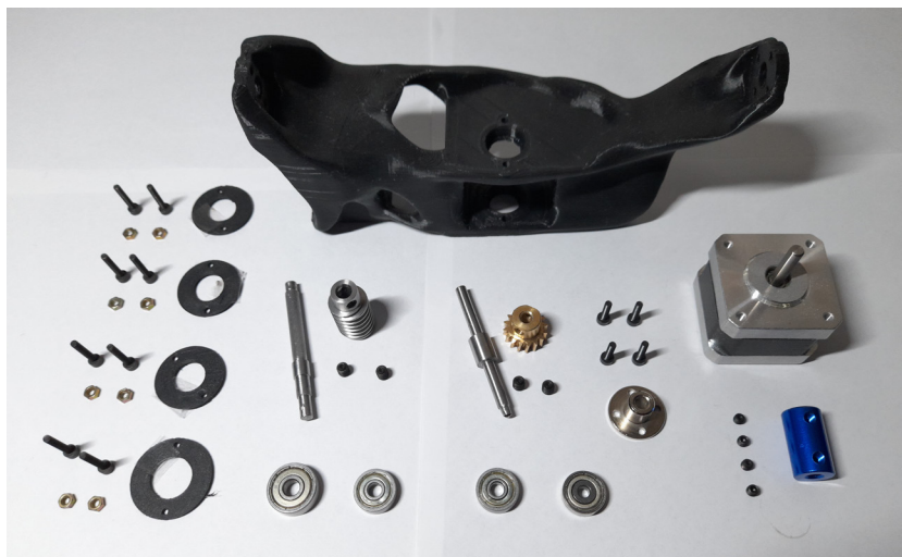
Figura 3-24: Piezas finales del sistema de giro
