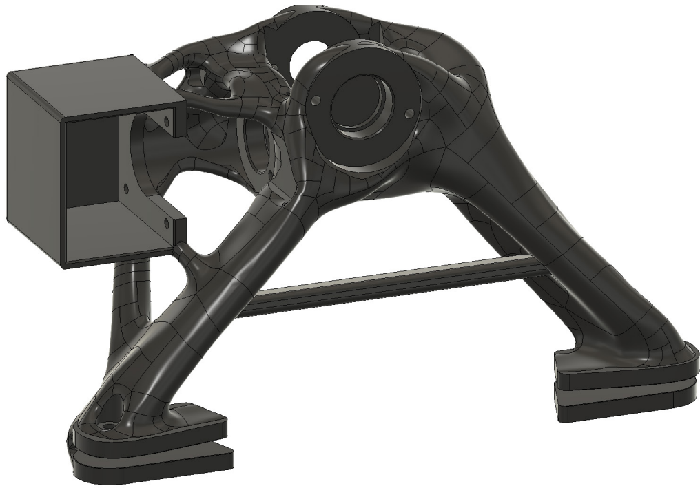
Figura 3-21: Diseño final estructura de balance trasera
