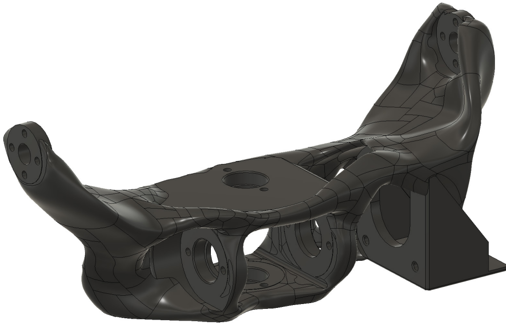
Figura 3-19: Diseño final estructura de giro
