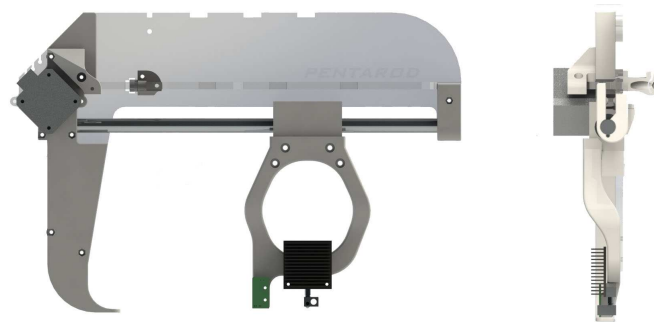
Figura 1-16: Extrusor modificado de la impresora 5-Axis. [28]
