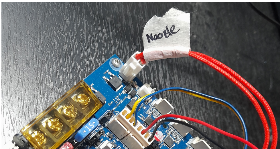
Figura 4-8: Conexión calentamiento del sistema extrusor
