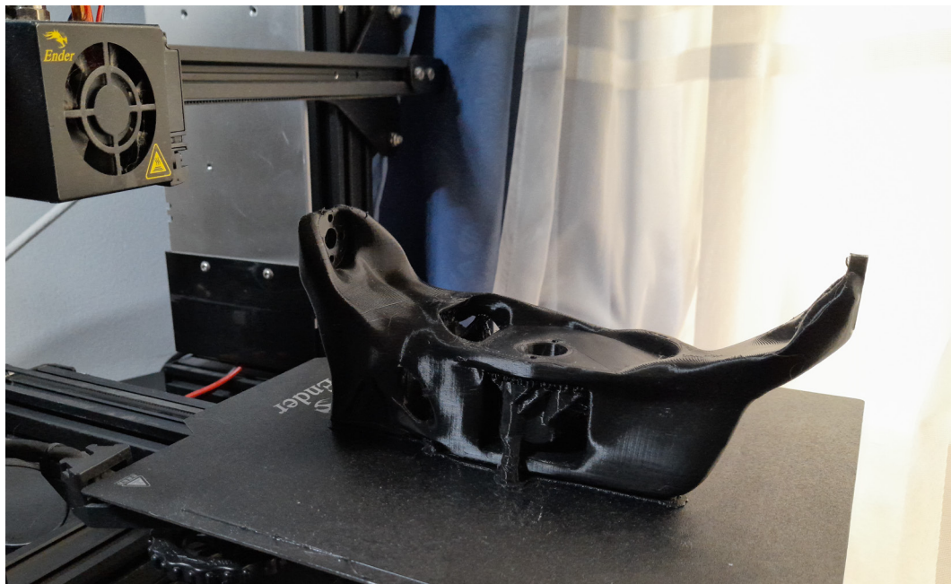
Figura 3-20: Fabricación pieza final sistema de giro
