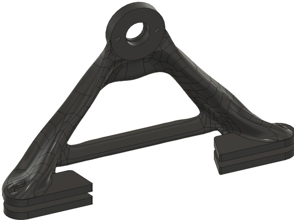
Figura 3-23: Diseño final estructura de balance delantera
