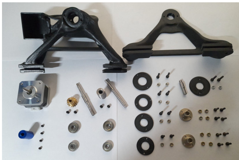
Figura 3-25: Piezas finales del sistema de balance
