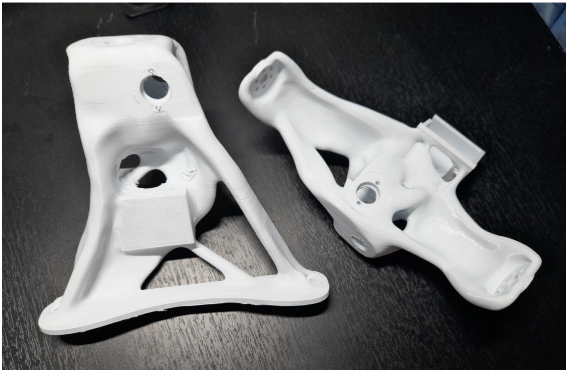
Figura 3-9: Primera versión piezas del mecanismo de 5 ejes
