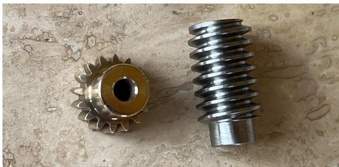
Figura 3-4: Transmisión Engranaje Sinfín corona
