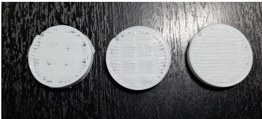
Figura 5-5: Pruebas de factor de flujo. De izquierda a derecha: 100 % - 105 % - 110 %.
