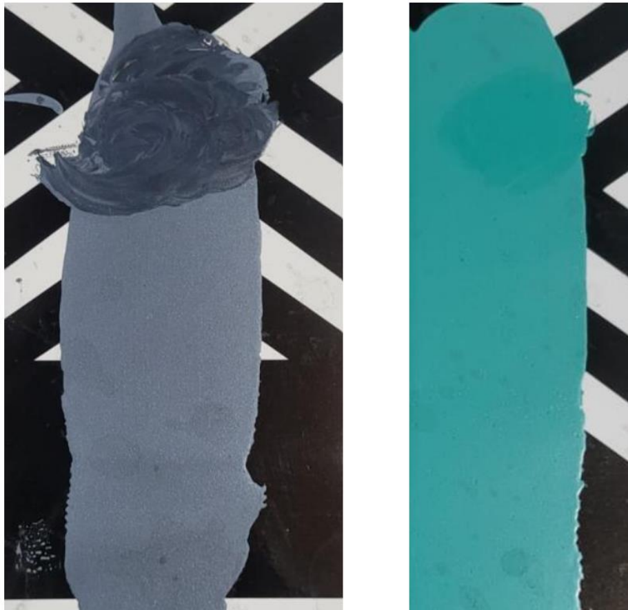
Figura 5-13. Evidencia de incompatibilidad en los concentrados negro y verde por ensayo rub-out.
