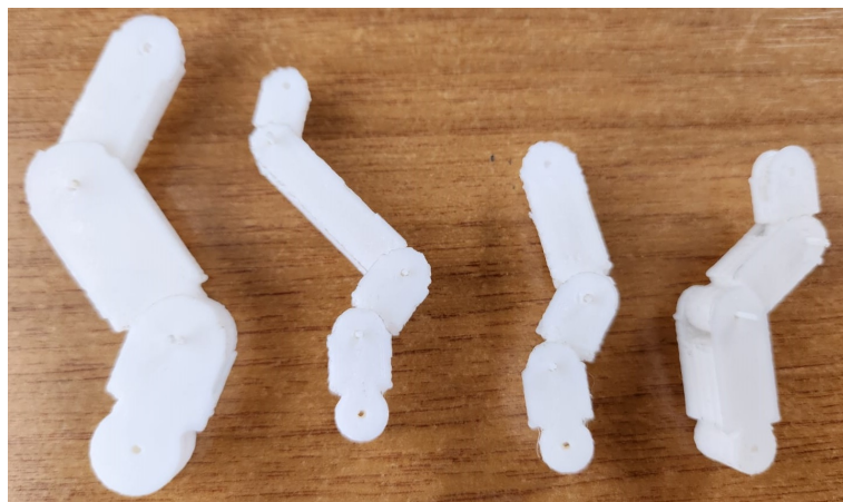
Figura E-13.: Ensamblaje de pines con tolerancia de 0.6 y 0.7 mm de todos los estudiantes.
