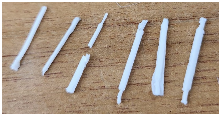
Figura E-11.: Probetas de tolerancia 0.2mm a 0.7 mm.
