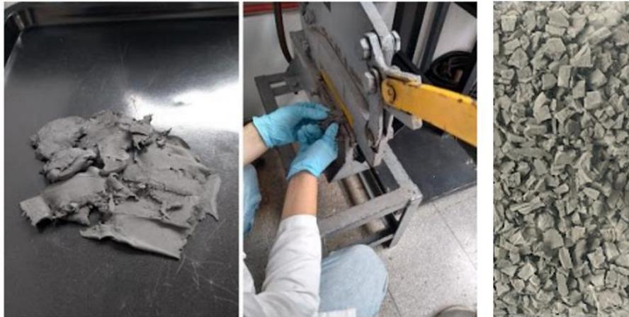
**Figura 1-7:** Proceso de pelletizado para fabricación del filamento, (izq.) solidificación de la mezcla, (centro) corte en cizalla, (der.) pellets obtenidos. [Autor]
