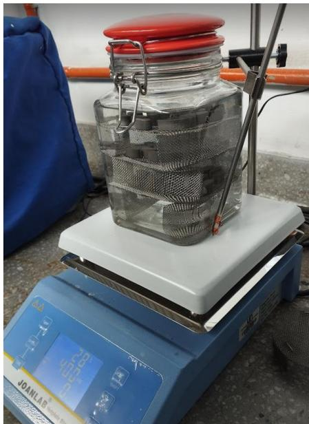
**Figura 3-6:** Disposición y montaje del proceso de despolimerización química. [Autor]
