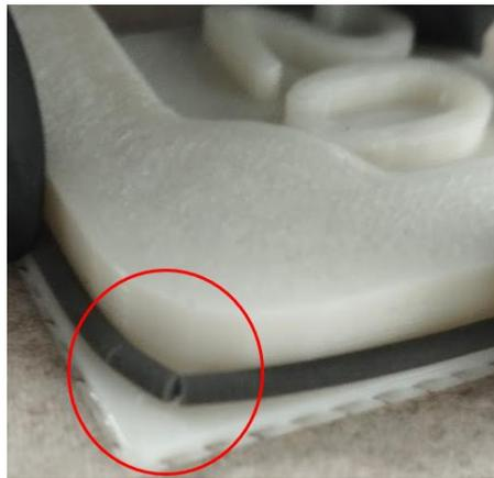
**Figura 1-13:** Comportamiento del filamento en galga de 20 mm de radio de curvatura, con detalle de rotura completa en el radio máximo. [Autor]
