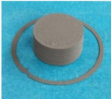
**Figura 2-4:** Probeta en verde recién terminado el ciclo de impresión. [Autor]
