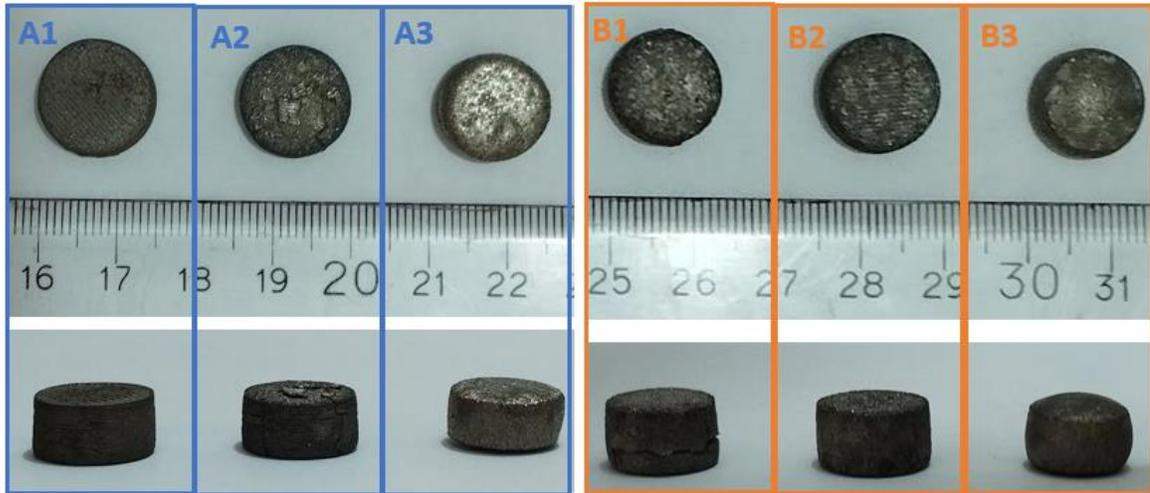
**Figura 3-22:** Vistas superior y lateral a nivel macroscópico de las probetas sinterizadas para cada tratamiento. A1: 1350°C-60min, A2: 1350°C-90min, A3: 1350°C-120min, B1: 1400°C-60min, B2: 1400°C-90min y B3: 1400°C-120min. [Autor]
