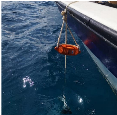
Figura 1.2. Fondeo de sensores en campaña de campo del 4 al 14 de noviembre de 2021. a) frente arrecifal y ubicación del sensor Doppler AWAC621, b) fondeo del sensor AWAC121 sobre fondos
