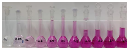
Figura 3.8. Cuantificación de Cr (VI) por reacción con el acomplejante 1,5-Difenilcarbazida. Tomado de Ashley et al. (2003).
