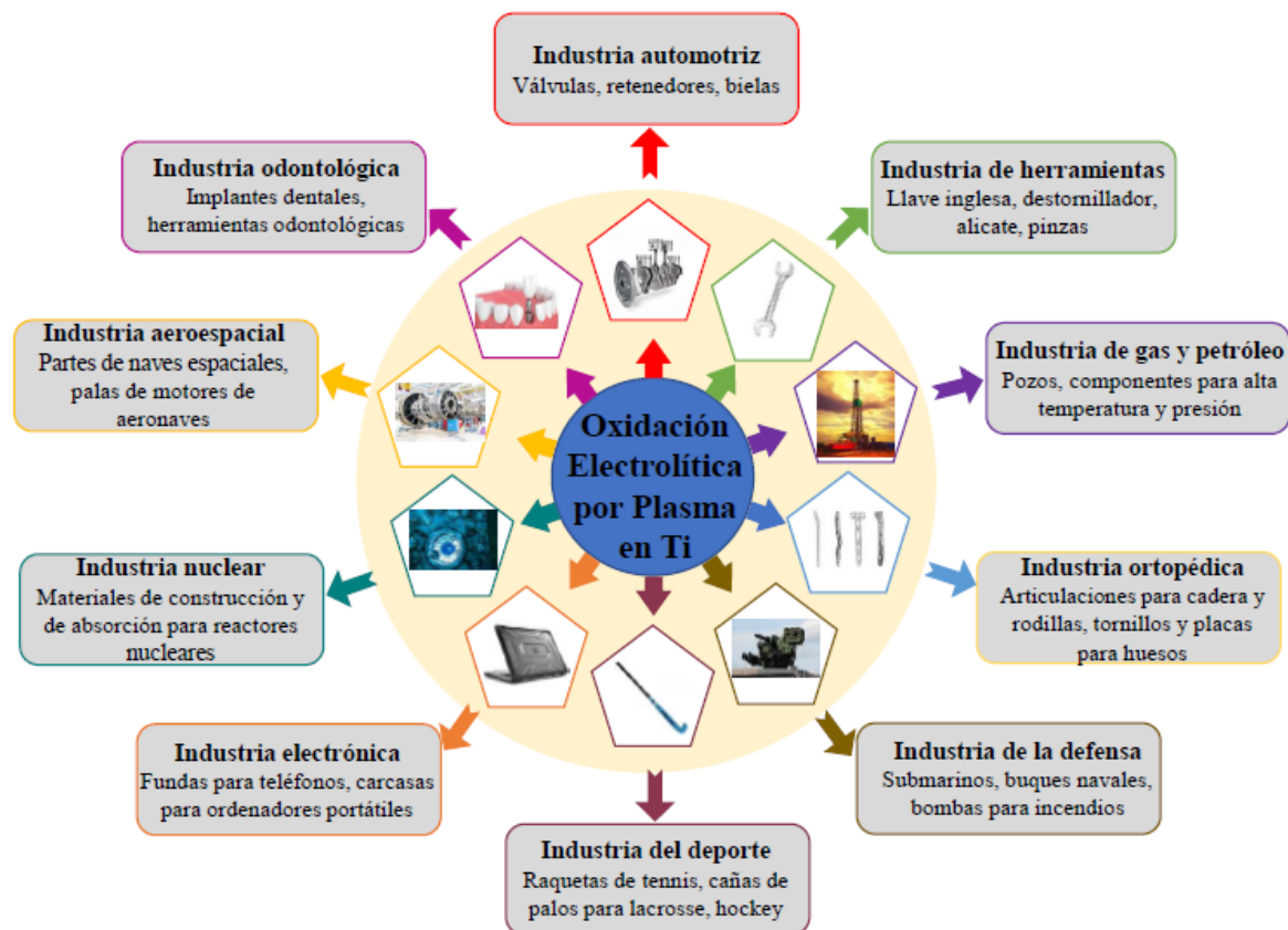
Figura 2.12. Aplicaciones de PEO sobre sustratos de titanio en diferentes tipos de industrias. Adaptado de Aliofkhazraei et al. (2021, p. 3).
