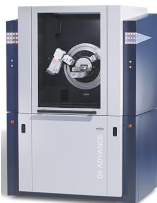
Figura 3.4. Diffractómetro de rayos X (XRD) Bruker. Tomado de Bruker (2022).
