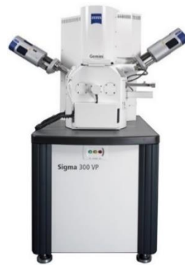
Figura 3.2. Microscopio Electrónico de Barrido de Emisión de Campo (FE-SEM) Carl Zeiss. Tomado de Carl Zeiss AG (2022).
