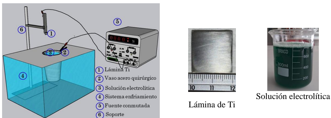
Figura 3.1. Ilustración de síntesis de recubrimientos de TiO 2 /Ni mediante PEO.
