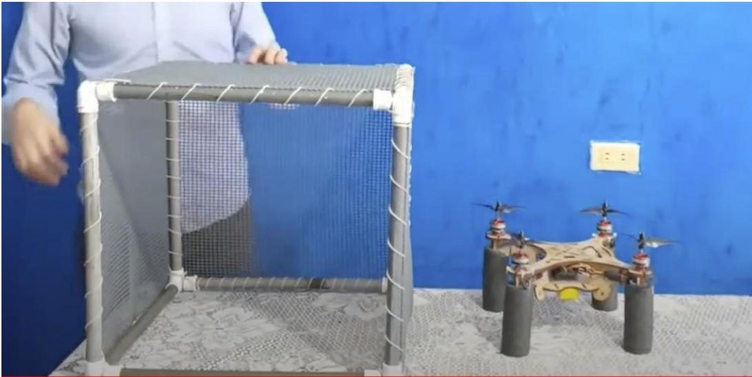
Figura 11 Estación de trabajo para el laboratorio de motores. Formado de una malla y tubos de pvc con configuración cúbica, sería un espacio seguro donde los riesgos serían minimizados. Su simpleza y modularidad permiten que sea transportable (captura de pantalla del video tutorial de cómo ensamblar la estación de trabajo, cortesía de L)
