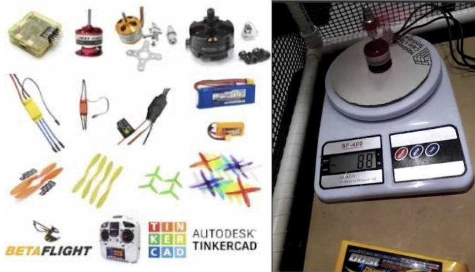
Figura 14 Materialidades necesarias para iniciar el ensamble del vuelo del dron. En la imagen de la izquierda, los distintos tipos de motores y hélices, cables, variador de velocidad, tarjeta de vuelo y baterías. En la derecha, una gramera para medir cómo los motores y las hélices ejercen fuerza a medida que se varía la velocidad del motor a través del variador de velocidad.
