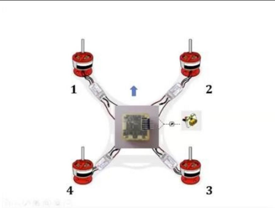
Figura 23 Tarjeta de vuelo en la estructura cada vez más desarrollada del dron. Este pequeño dispositivo controla la direccionalidad del vuelo del dron. Muy importante para cumplir su rol social, el del mejoramiento de la sociedad y el beneficio de las personas. La posición de la tarjeta de vuelo también es central. La relevancia de este dispositivo es alta, ya que los motores van conectados a esta tarjeta.
