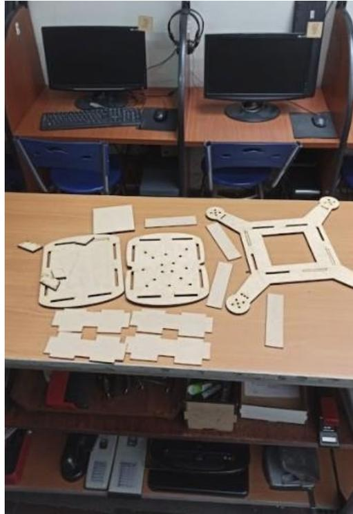
Figura 13 Estructura principal de un dron debidamente cortada de acuerdo al dron renderizado. Este proceso fue llevado a cabo en cualquier papelería que ofreciera el servicio de corte o impresión 3D que quedara próxima a las casas de los estudiantes (imagen cortesía de L)
