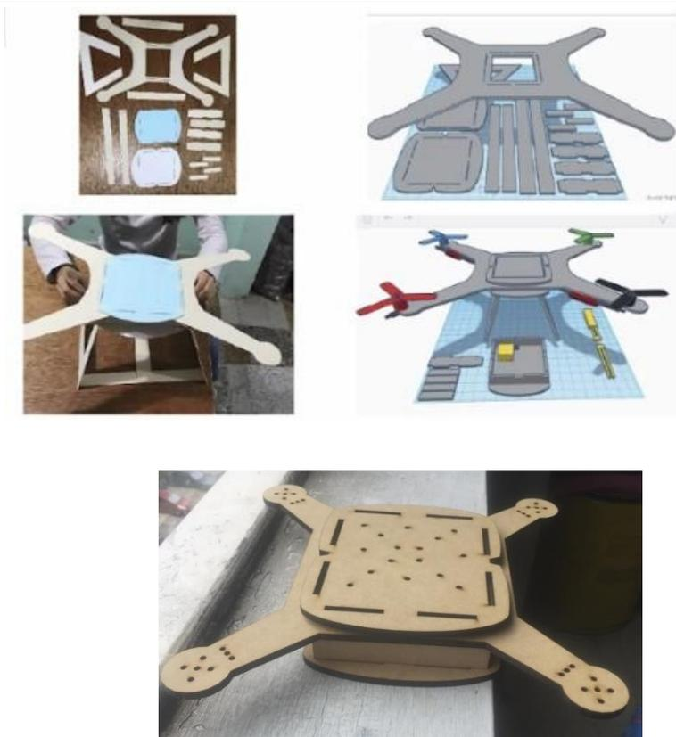
Figura 30 El dron de cartón paja materializado con distintos materiales y prácticas, el dron renderizado y el dron de madera aglomerada.
