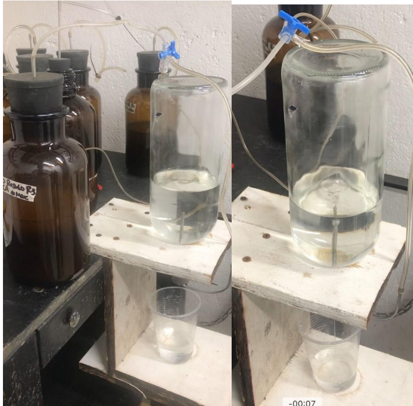
A. Reactores batch de 1.1 L
