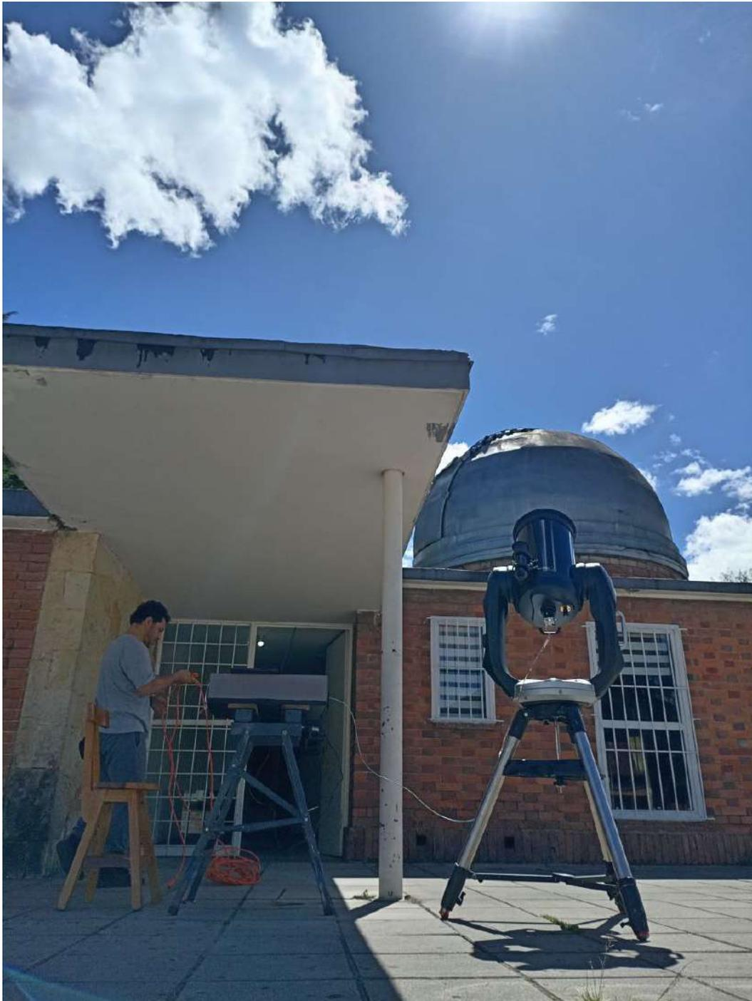
**Figura 4-10.:** Montaje dispuesto para la observación Solar usando una Cámara Heliosférica para Imágenes espectrales. Foto tomada el día 3 de Junio del 2023 alrededor de la 1:30 pm.
