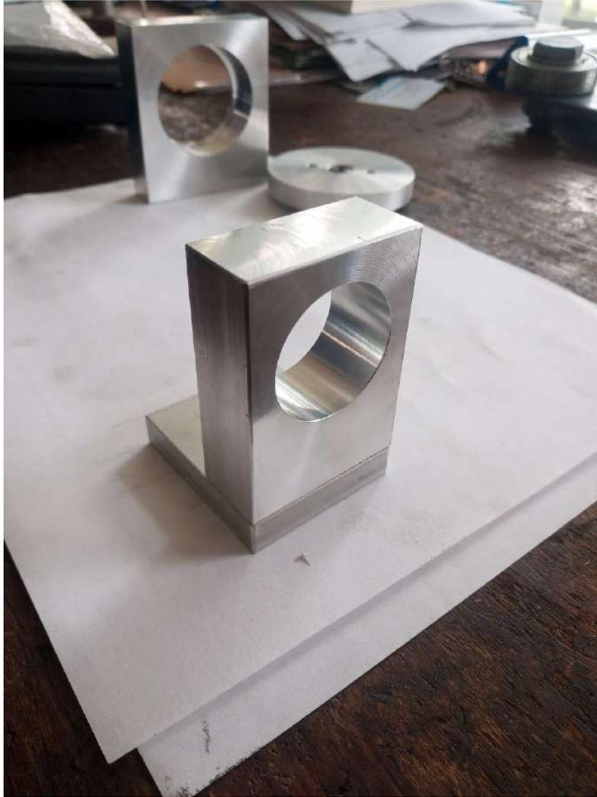
**Figura 3-4.:** Imagen previa del soporte de la cámara.
