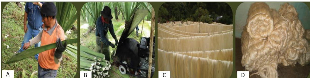
Figura 2-11. Registro fotográfico proceso de fabricación fibras largas Fique. A). Retiro de espinas. B). Desfibrado. C). Secado D). Empaque. Fuente: (Duque, 2011)
