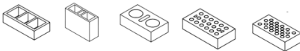
Figura 2-2. Unidades de perforación vertical. Fuente: NTC 4205-1
