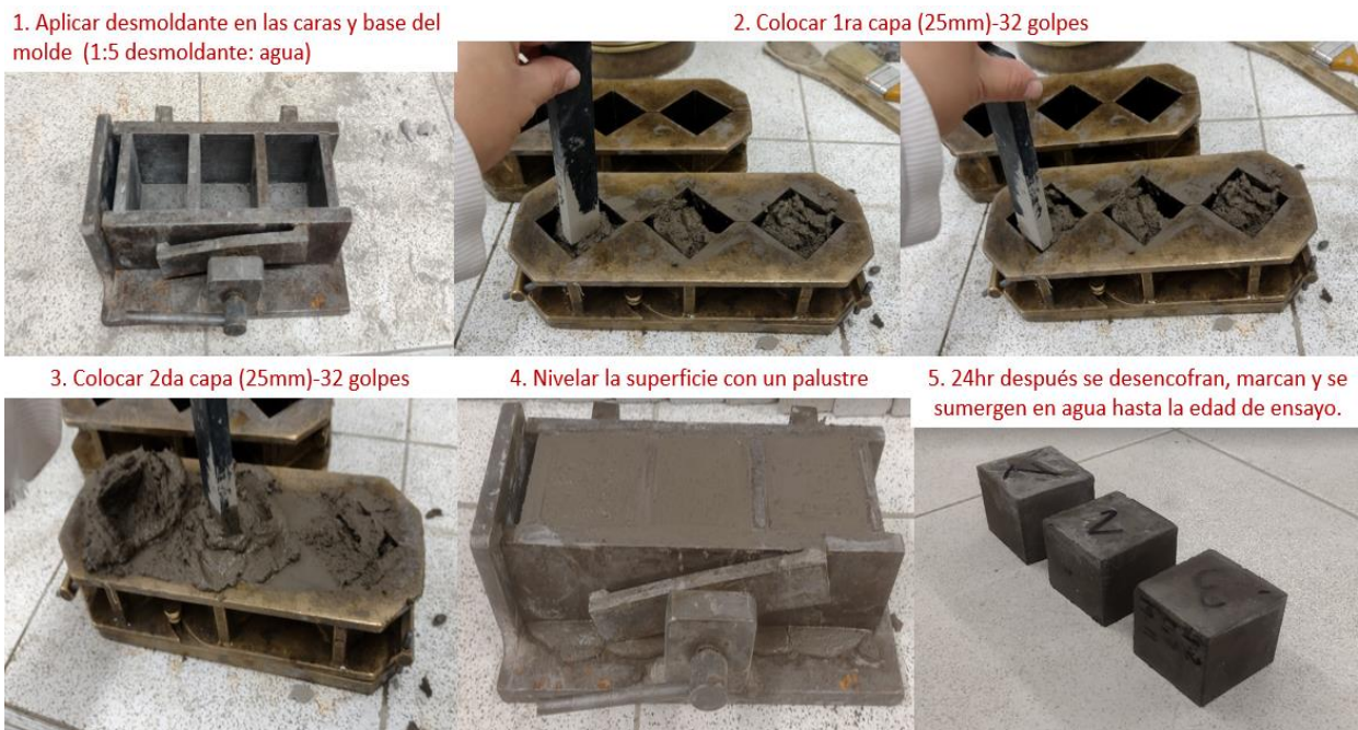
Figura 3-35. Procedimiento ensayo de resistencia a la compresión - Mortero
