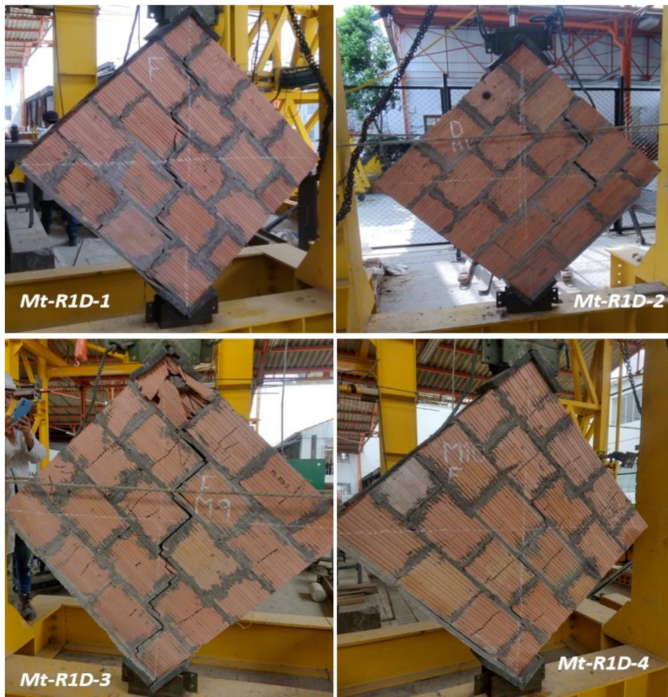
Figura 4-20. Registro fotográfico durante la falla de los muros Mt-R1D
