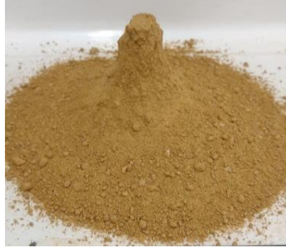
Figura 3-5. Muestra en condición Saturada y Superficialmente Seca
