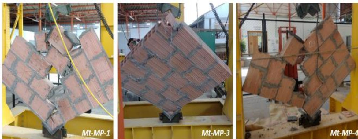
Figura 4-18. Registro fotográfico durante la falla de los muros Mt-MP
