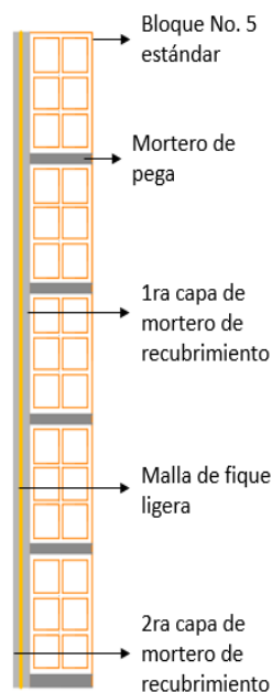
Figura 3-40. Configuración en capas de los muros del lote Mt-R1L, vista Lateral
