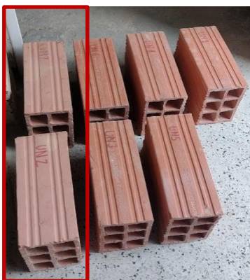
Figura 4-2. Unidades de mampostería sujetas a ensayo a compresión
