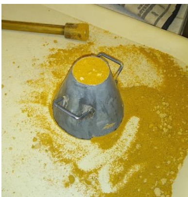
Figura 3-4. Montaje de ensayo de Humedad Superficial
