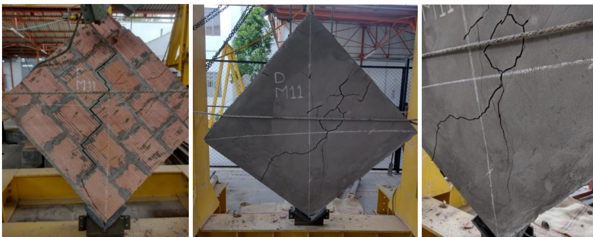
Figura 4-24. Falla por deslizamiento por cortante en muro Mt-R1L-4
