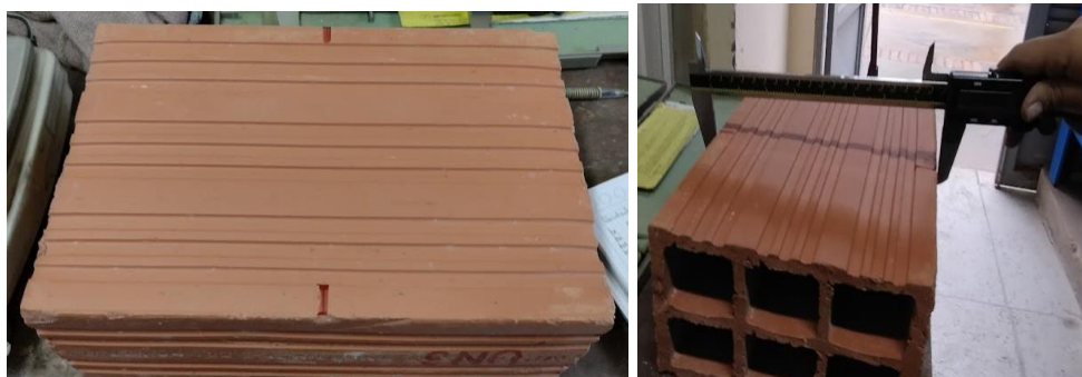
Figura 3-14. Marcación de centros y medición de altura.
