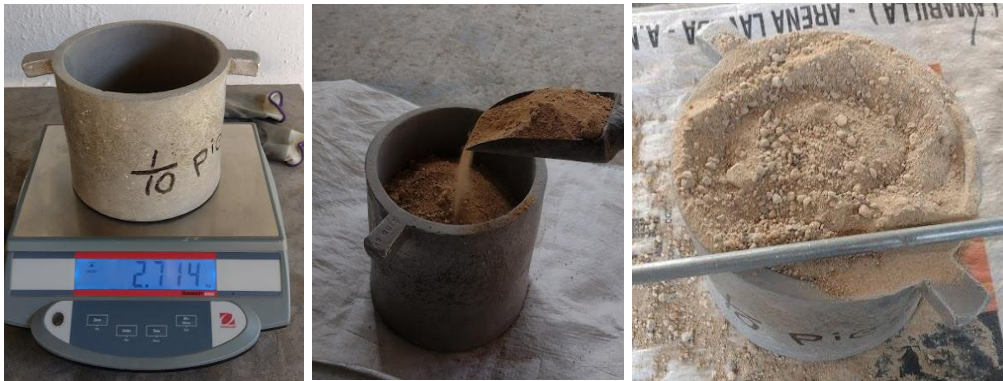
Figura 3-7. Registro fotográfico determinación masa unitaria suelta.
