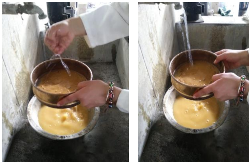
Figura 3-6. Proceso de lavado de material sobre el tamiz de 75\mu\text{m} (No. 200)
