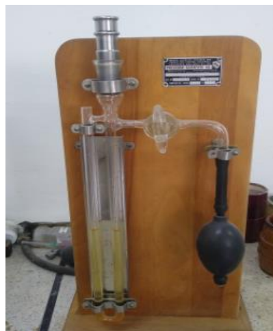
Figura 3-2. Aparato de Blaine para determinación de módulo de finura
