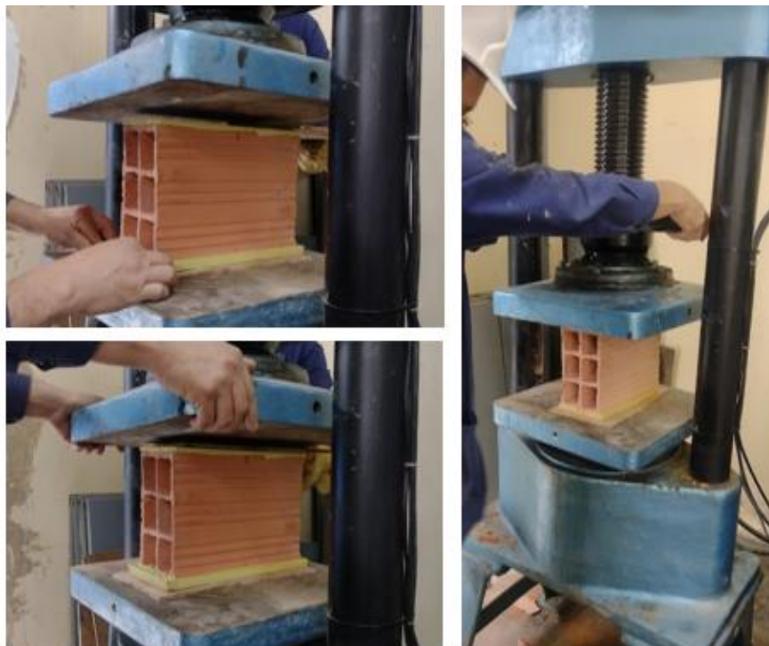
Figura 3-21. Montaje ensayo de resistencia a la compresión unidades de mampostería.
