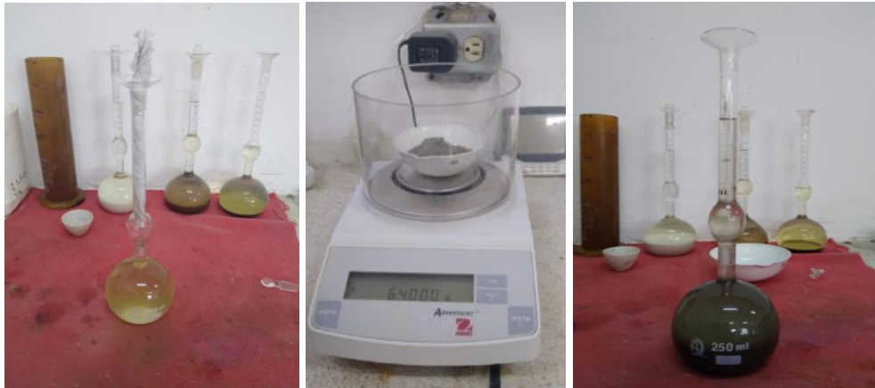
Figura 3-1. Registro fotográfico del procedimiento para determinación de densidad en cemento
