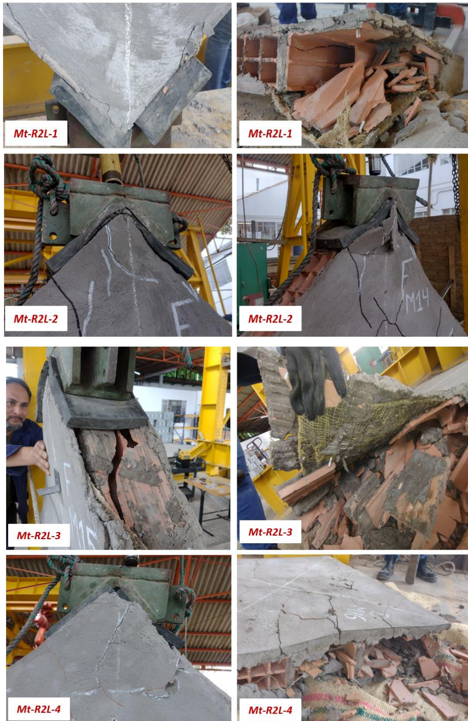
Figura 4-29. Registro fotográfico falla por aplastamiento en los apoyos Mt-R2L
