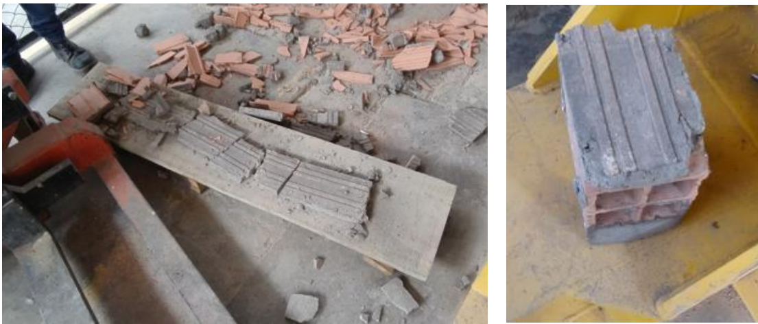
Figura 4-19. Falla por desprendimiento de mortero de pega en muro Mt-MP-2
