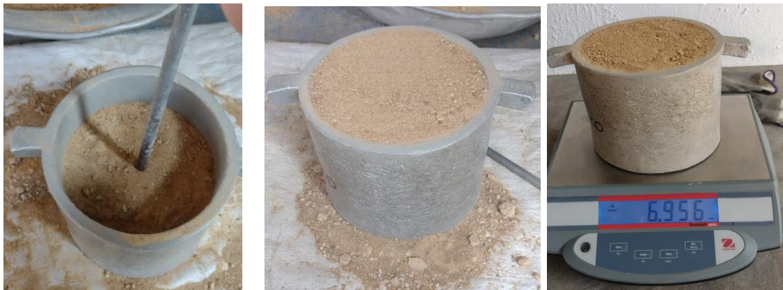
Figura 3-8. Registro fotográfico determinación masa unitaria compactada
