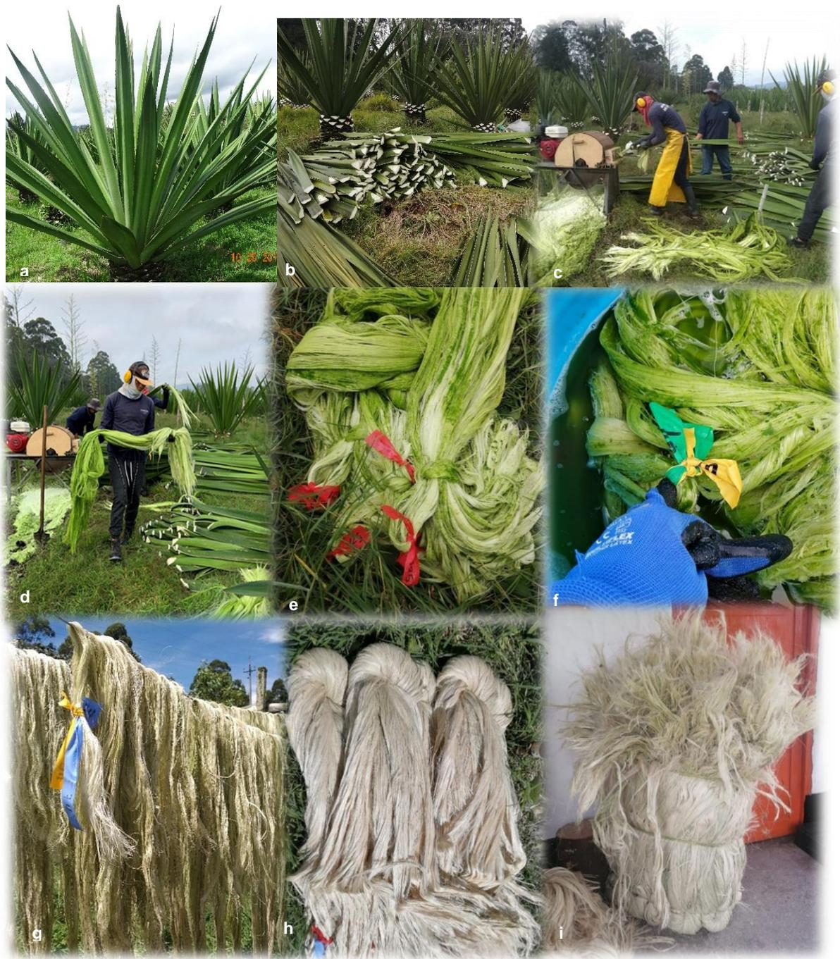
Figura 1. Proceso de extracción de fibra de fique: a) planta óptima para cosecha, b) corte de hojas, desespine y acarreo al punto de desfibrado, c) desfibrado de hojas en maquina manual, d) fibra de fique recién desfibrada de la hoja, e) rotulación de fibra por accesión, f) fermentación de fibra, g) secado de fibra en los tendedores, h) empaque de fibra seca, i) empaque para llevar a punto de acopio.
