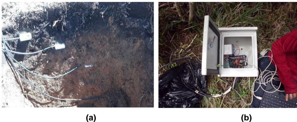
**Figura 3.12:** Distribución espacial de los sensores de humedad del suelo (TDR, Campbell) (a) y estación de monitoreo de la humedad del suelo (b).
