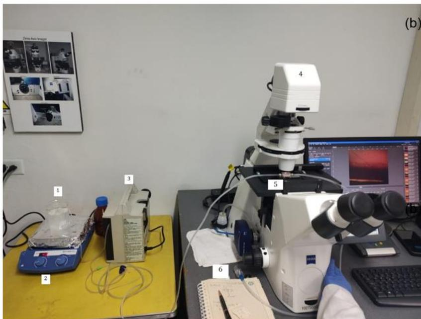
A la salida del dispositivo se recolectó el líquido enriquecido en rodamina. Para ello se dispuso de un vial en donde se recogían las gotas de líquido desde el inicio del experimento hasta los 15 minutos, un segundo vial recogía el líquido desde los 15 minutos hasta los 30 minutos y un tercer vial recibía el líquido de los 30 minutos hasta el final del experimento (a los 45 minutos).
