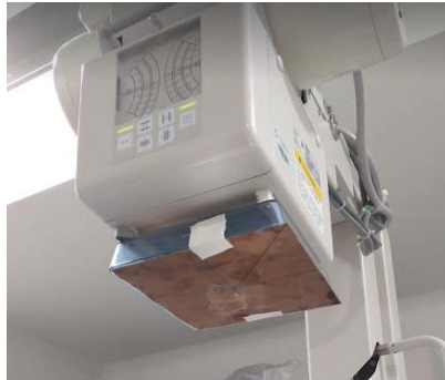
Figura 2.8 Montaje experimental para la prueba de dosis máxima en el II
