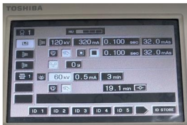
Figura 3.6 Imagen de la información que se registra para calcular el kerma en la superficie de entrada.
