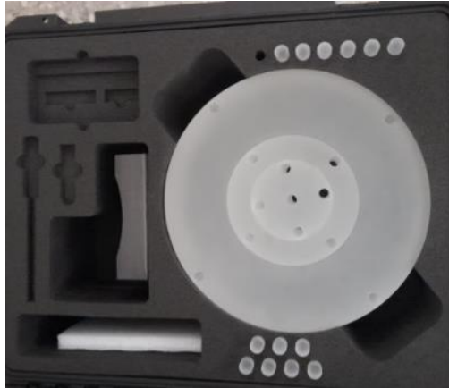
Figura 2.6 Phantom RaySafe Pro-CT Dose usado para dosimetría en TC
