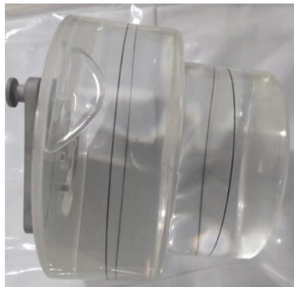
Figura 2.4 elemento de prueba Phantom S/SS utilizado para evaluar uniformidad y ruido.
