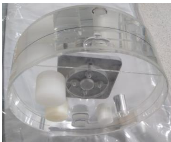
Figura 2.5 Phantom TOS de Toshiba, elemento de prueba para evaluar número CT
