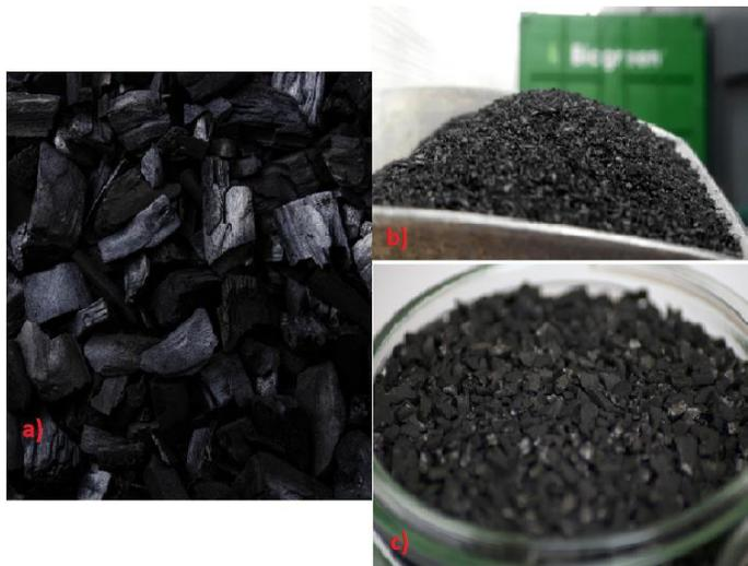
Figura 3. Carbón vegetal (a), biochar (b) y carbón activado (c). Adaptado de [26]–[28].
