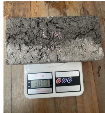
Ilustración 43 Primera medición de peso del elemento parcialmente sumergido en agua. Fuente: Propia
