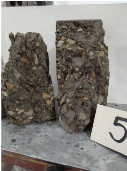
Ilustración 24 Falla de la muestra de concreto 210Kg/cm 2 con el 2% de madera
