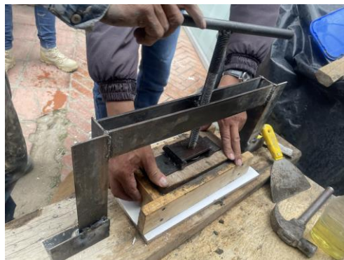
Ilustración 32 Presión realizada para la compactación en cada capa. Fuente: Propia
