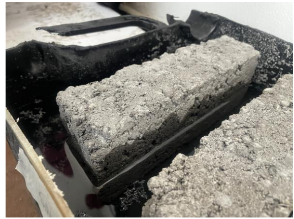
Ilustración 37 Absorción de las primeras 24 horas. Fuente: Propia
