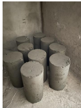
Ilustración 20 Muestra desencofrada 24h después Fuente propia
