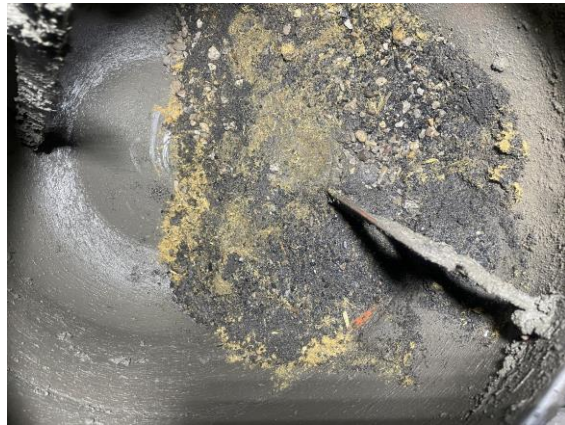
Ilustración 15 Adicionan del aserrín de madera a la mezcla
