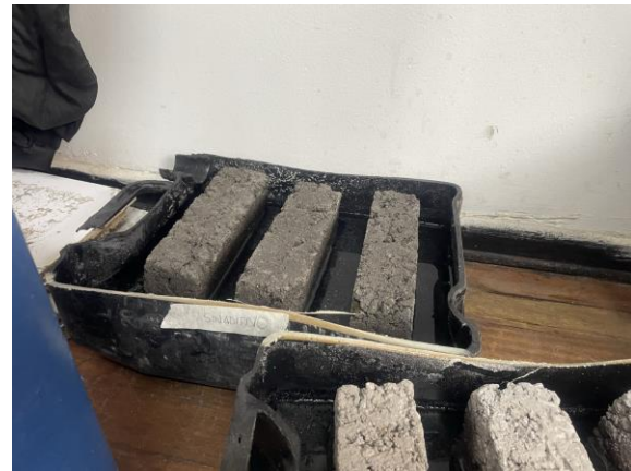
Ilustración 39 Absorción total de la muestra durante el ensayo. Fuente: Propia
