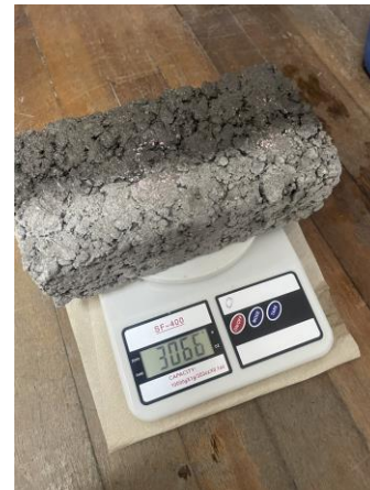
Ilustración 45 Ultima toma de peso del ladrillo parcialmente sumergido en agua. Fuente: Propia
