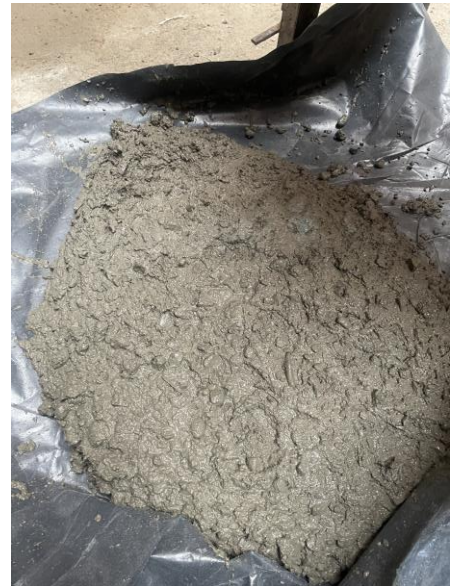
Ilustración 17 Mezcla de concreto con madera Fuente propia
