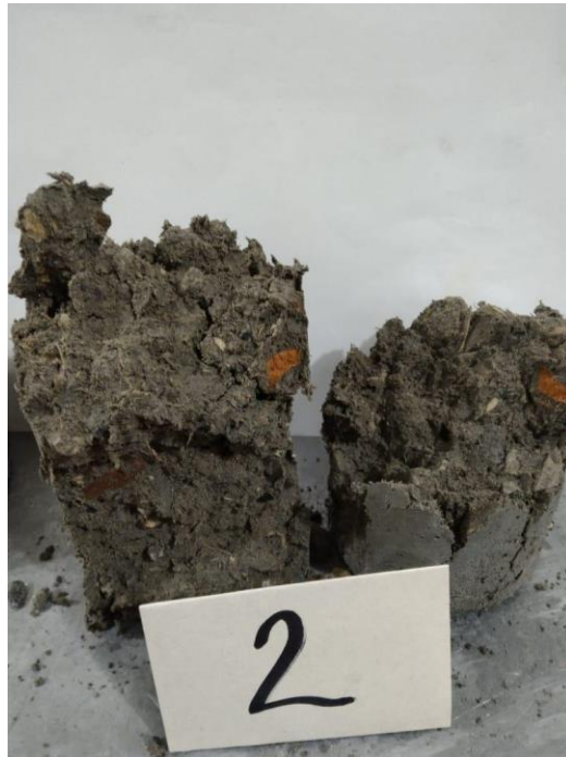
Ilustración 28 Falla de la muestra de concreto 210Kg/cm 2 con el 15% de madera
