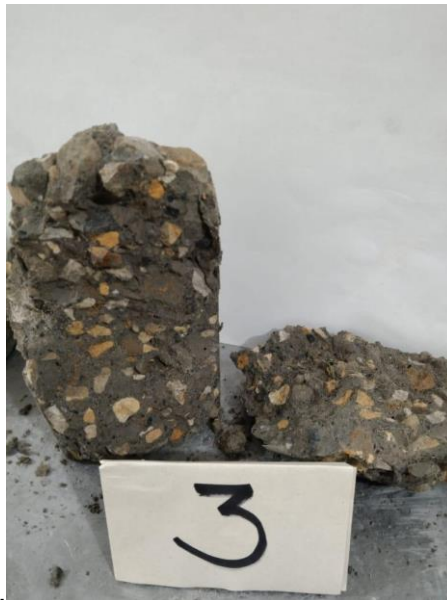
Ilustración 22 Falla de la muestra de concreto 210Kg/cm 2 sin madera
