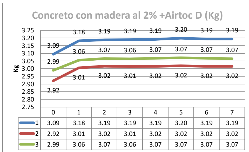
Ilustración 46 Peso de ladrillo con 2 % de madera más aditivo Airtoc D sumergidos en agua. Fuente: Propia
