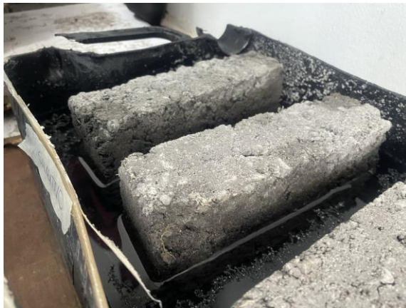
Ilustración 38 Absorción del ladrillo durante el ensayo. Fuente: Propia
