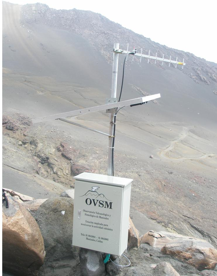
Figura 2-2.: Estación típica de monitoreo sísmico (perteneciente al OVSM). Imagen tomada de [Orozco-Alzate et al., 2012]
