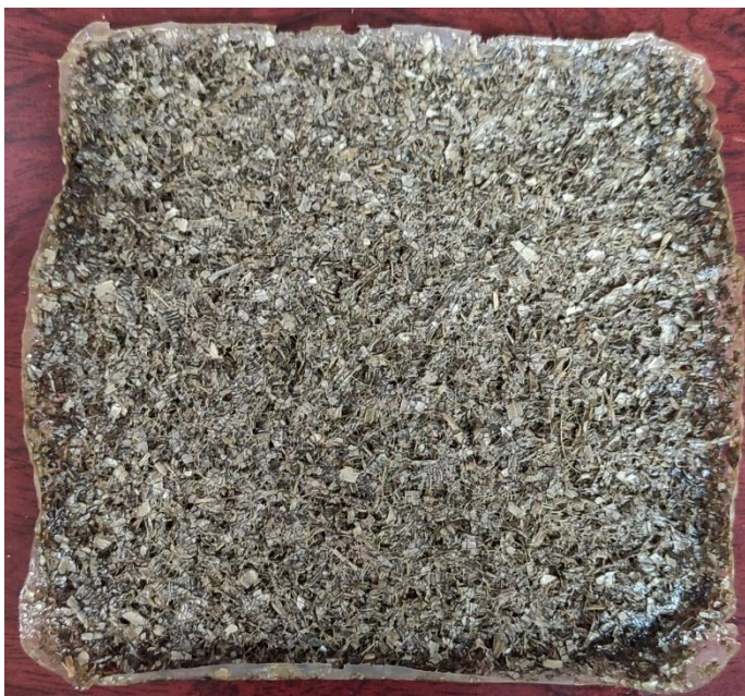
Figura 20-2: Lámina con 50% de fibra gruesa secada a 50°C
