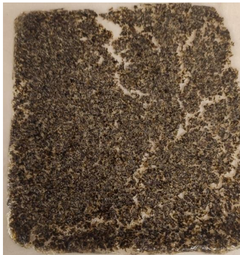
Figura 21-2: Lámina con 50 %p/p fibra/almidón secada a 50 °C con alta humedad
