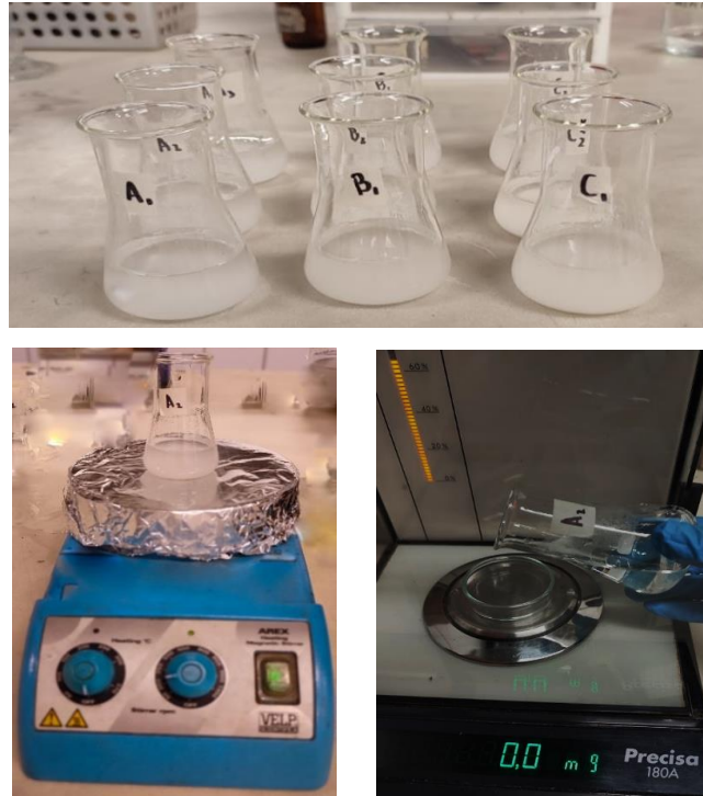
Figura 3-2: Preparación de la solución de almidón a diferentes concentraciones.
