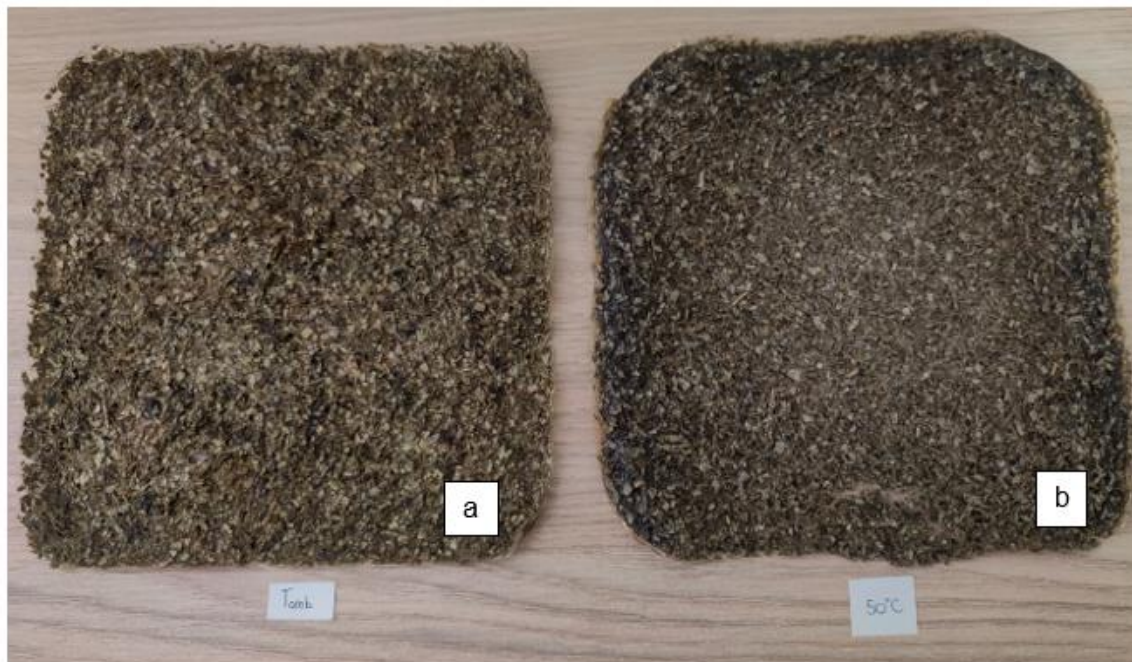
Figura 22-2: Lámina con 50% p/p fibra/almidón secadas a a) Temperatura ambiente b) 50° C
