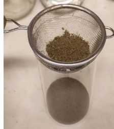
Figura 6-2: Tamizaje de la fibra inicial para obtener una fibra más fina.
