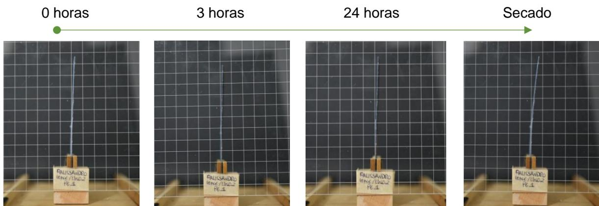
**Figura 83 :** Curvatura Circular (PA+Long+Lino2+Peg1)
