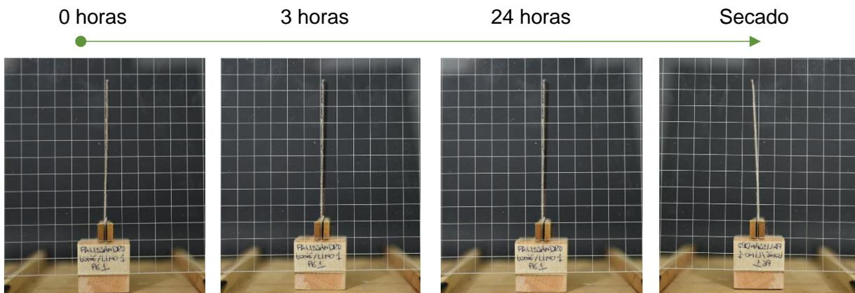
**Figura 81 :** Curvatura Circular (PA+Long+Lino1+Peg1)
